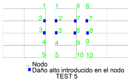
Figura 3-8 Test 5. Daño alto en 4 conexiones, nodos 3, 8, 2 y 7. En las barras transversales y en las barras longitudinales.
