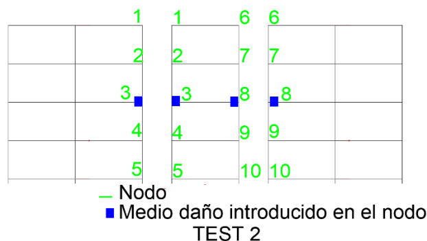
Figura 3-5 Test 2. Daño medio en dos conexiones: nodo 3 y 8 en las barras longitudinales y transversales.
