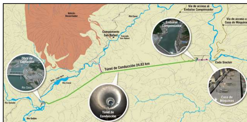
Ilustración 16. Estructura de las obras de la Central Coca Codo Sinclair (CCS) Fuente: (Ministry of Energy and Non-Renewable Resources of Ecuador, 2017b).
