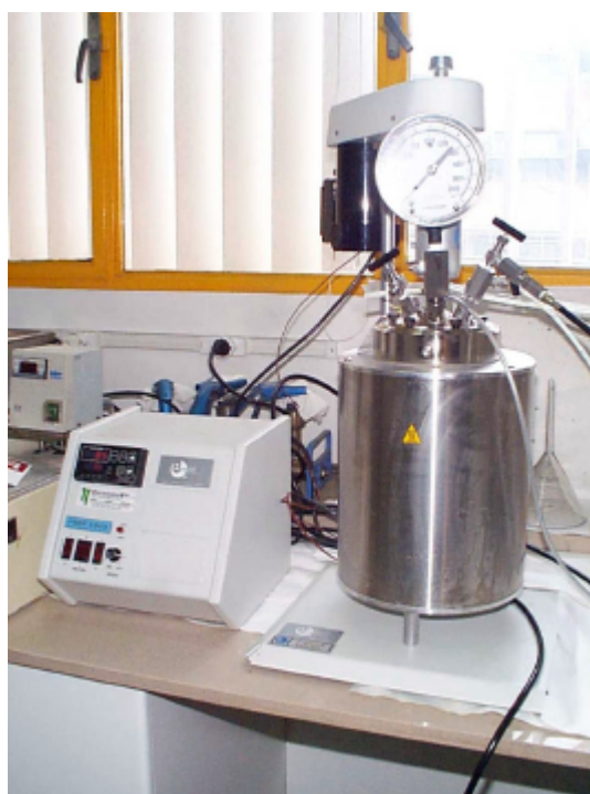
Figura 3.3. Reactor autoclave PARR 4843 de 2 L con agitación mecánica para muestreo “on line”.
