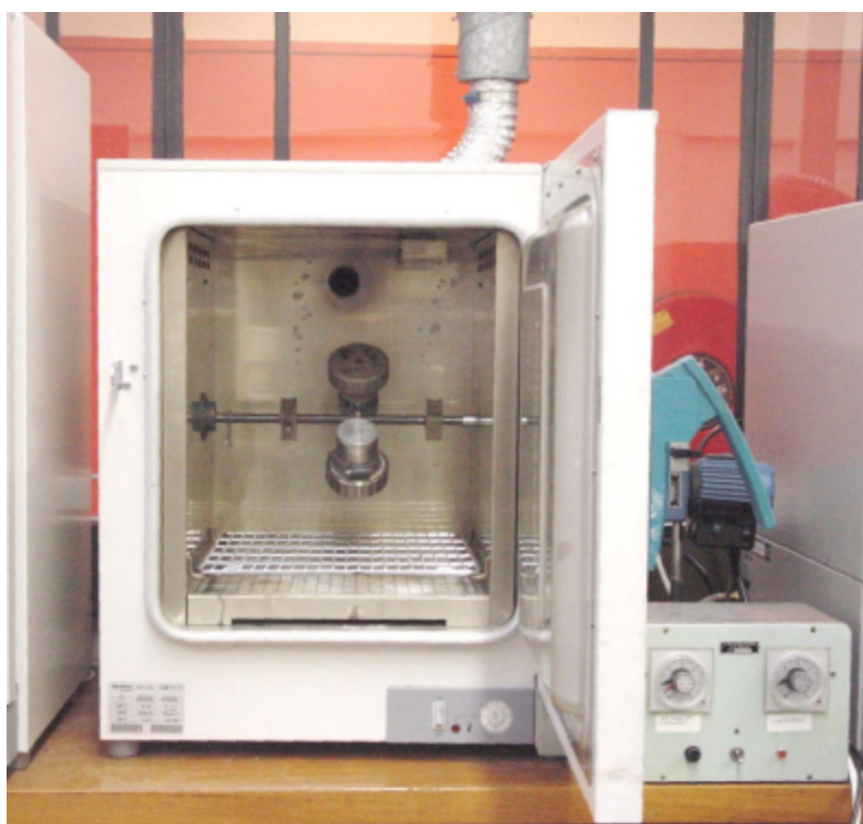
Figura 3.4. Estufa con agitación rotatoria utilizada en los experimentos de extracción a 150 y 175 °C.
