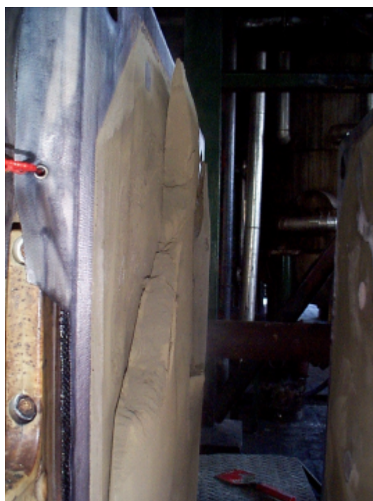
Figura 5.7. Filtros neumáticos prensa utilizados para lavar y secar el producto zeolítico en la empresa Clariant S.A.
