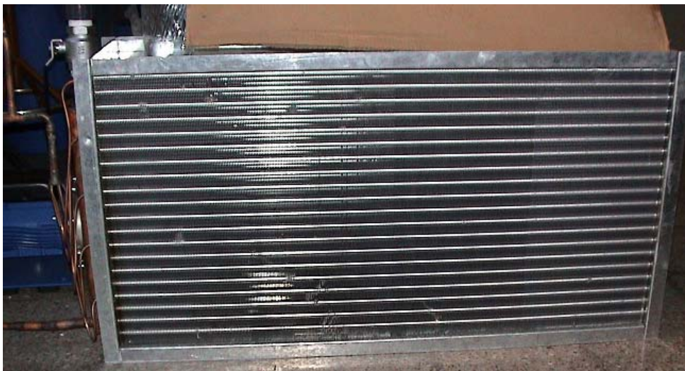
Fotografia 3.10. Condensador d'aire forçat. El vapor calent a alta pressió entra per la part inferior
