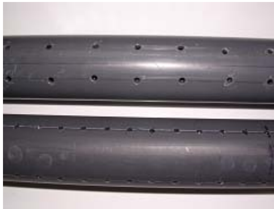
Fotografia 3.23. Comparació entre els forats dels tubs antics (dalt) i els nous (sota)
