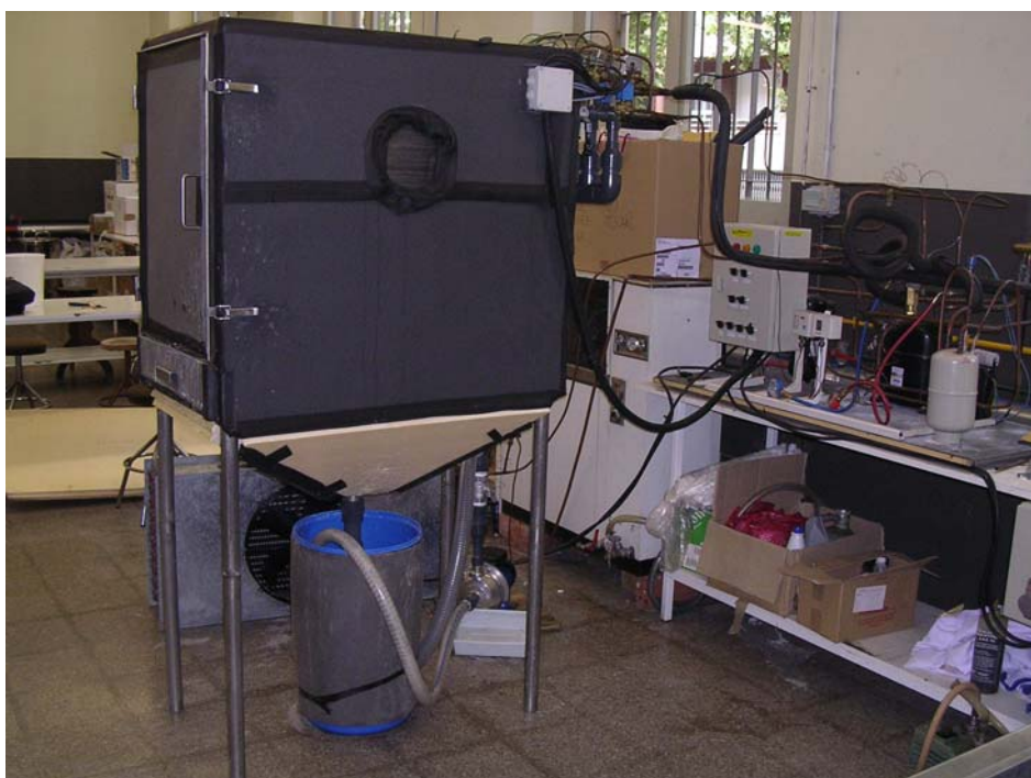
Fotografia 3.26. Prototip del crioconcentrador utilitzat en els assaigs amb sucres
