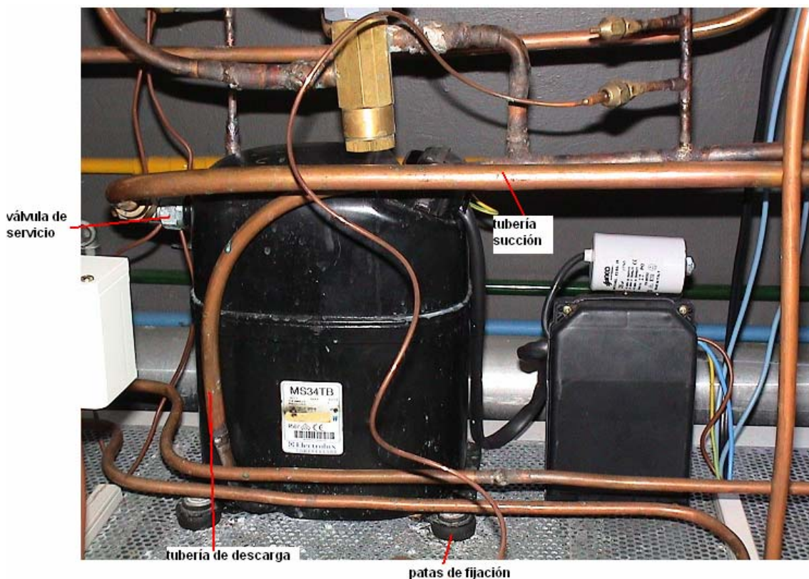
Fotografia 3.9. Compressor hermètic de l'equip de crioconcentració
