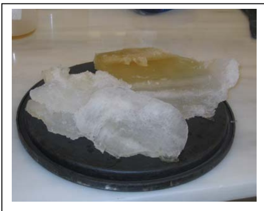
Fotos 4.2 i 4.3. Descongelació de gel de suc de pera a temperatura ambient
