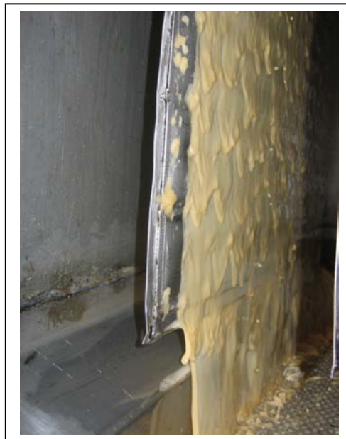
Foto 4.1. Flux de suc de pera sobre placa amb formació d'ones
