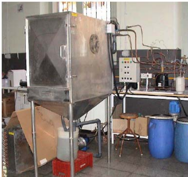
Fotografia 3.1. Primer prototip de crioconcentrador, situat a l'antiga Planta Pilot de l'Escola del C/ Urgell
