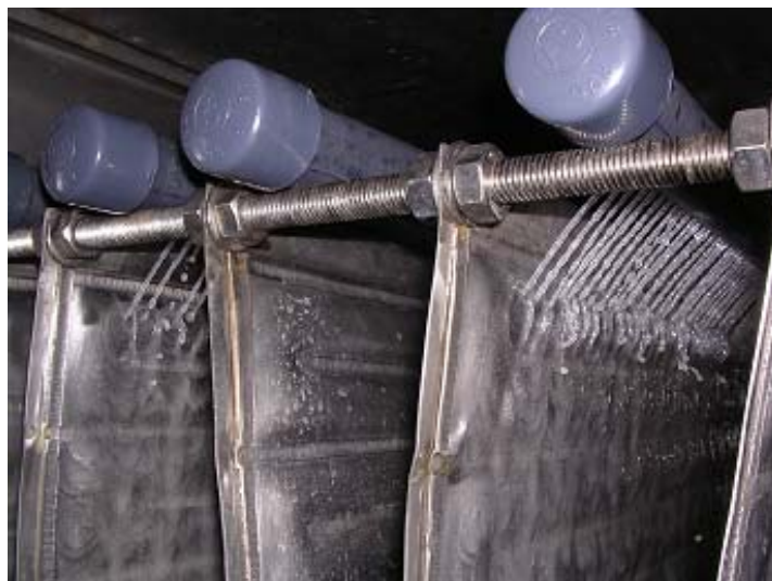
Fotografia 3.24. Detall de la sortida de la solució amb els nous tubs
