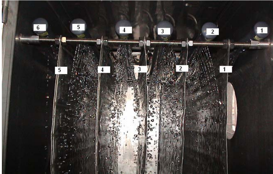
Fotografia 3.4. Numeració de les plaques evaporadores i distribuïdors
