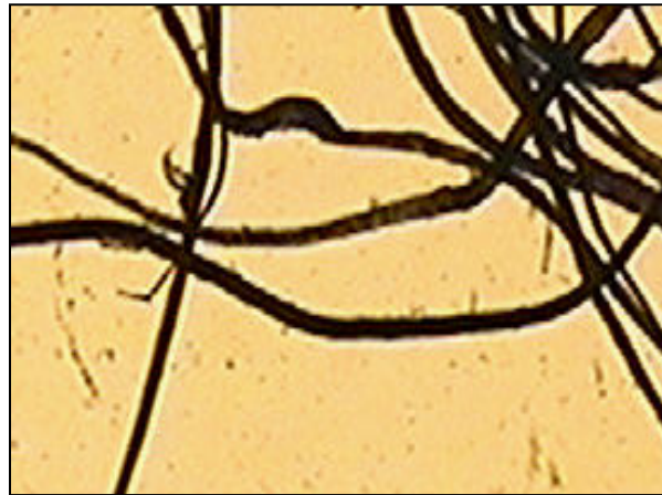
Figura 4.50 : Fotografia obtinguda per la fibra de jute sense tractar a 185 augments.
