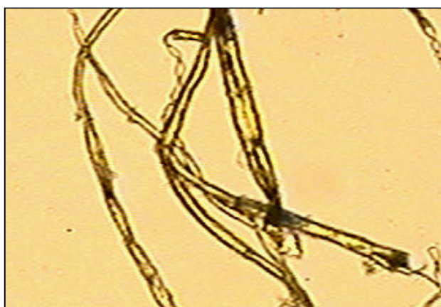
Figura 4.55 : Fibra de jute modificada en un percentatge del 44% durant 24h en piridina, a 185 augments.
