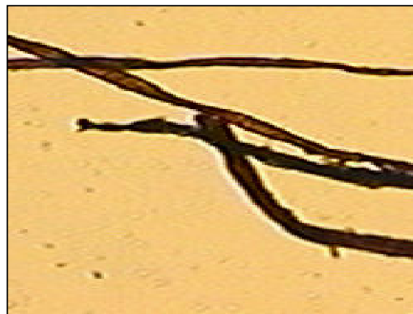
Figura 4.51 : Jute modificat en piridina en un percentatge del 2% durant 1 hora, a 185 augments.
