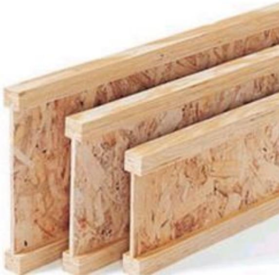
Los “I Joist” o perfiles compuestos en “I” están formados por un alma o red intermedia ubicada entre dos listones longitudinales ubicados arriba y abajo. El alma puede ser de madera contrachapada, madera laminada o de tableros OSB y los listones pueden ser de madera natural serrada o madera la minada.
