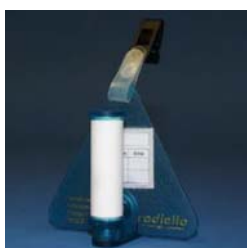
Figura 5.3. Captador pasivo Radiello montado (R&P-Co, 2001)
