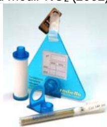
Figura 7.4. Componentes de un captador pasivo Radiello (2002)
