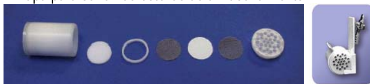
Figura 7.1. Partes del captador pasivo Ogawa (Ogawa, 2001)
