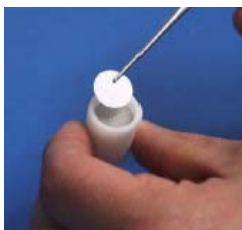
Figura 7.2. Ensamblaje de los filtros captador pasivo Ogawa (Ogawa, 2001).
