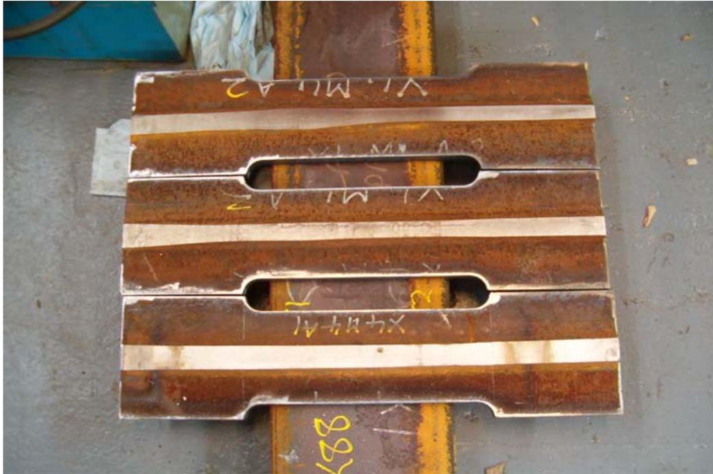
Fig. 5.22. Fotografía de tres de las probetas mecanizadas para la realización de los ensayos estructurales.
