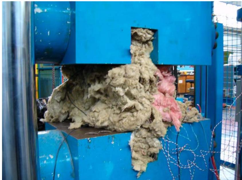
Fig. 5.29. Material aislante rodeando la probeta de ensayo.
