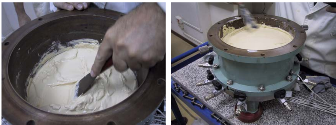
Figura E.10. Proceso de preparación de la muestra. Colocación del caolín amasado dentro de la célula.
