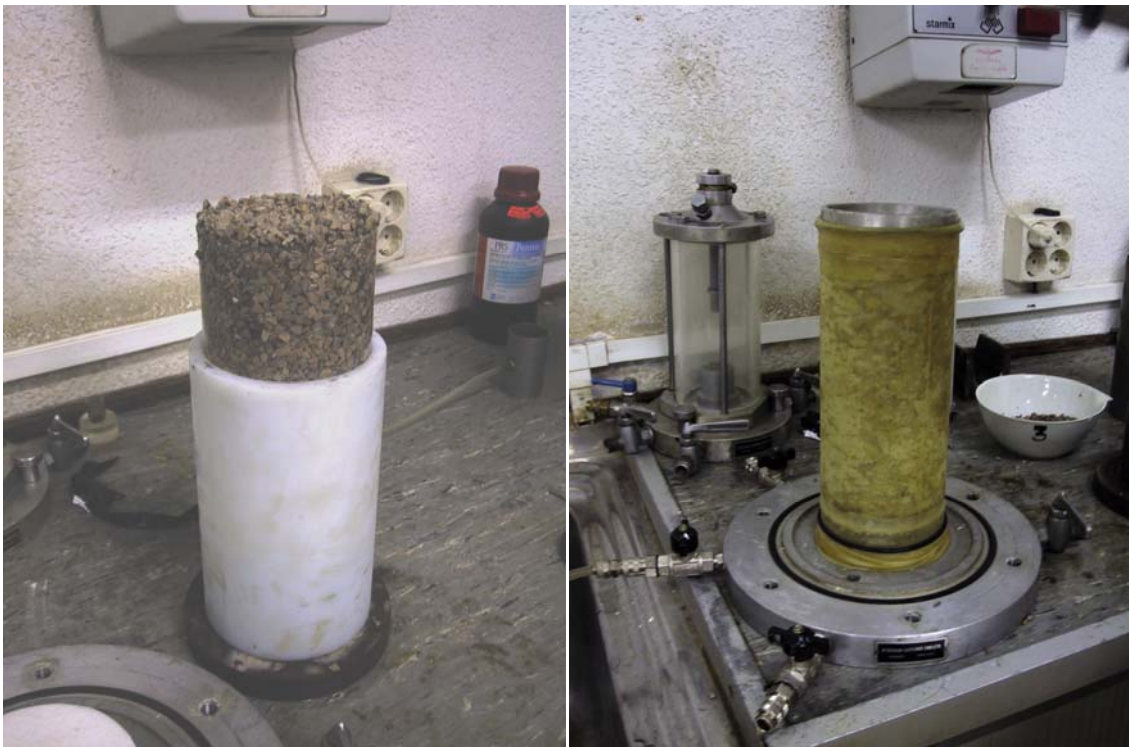
Figura E.6. Probeta de grava fabricada por congelación para el ensayo de compresión triaxial consolidado drenado
