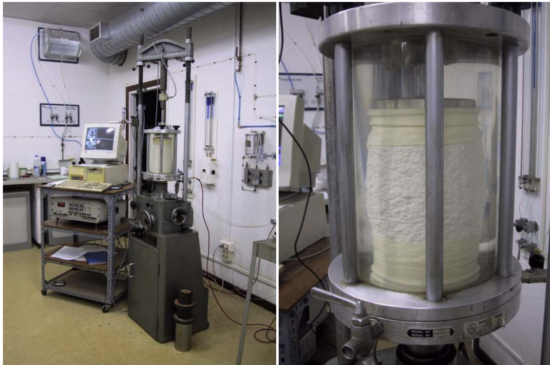
Figura E.7. Prensa para la realización del ensayo de compresión triaxial en la grava. Probeta deformada una vez finalizado el ensayo
