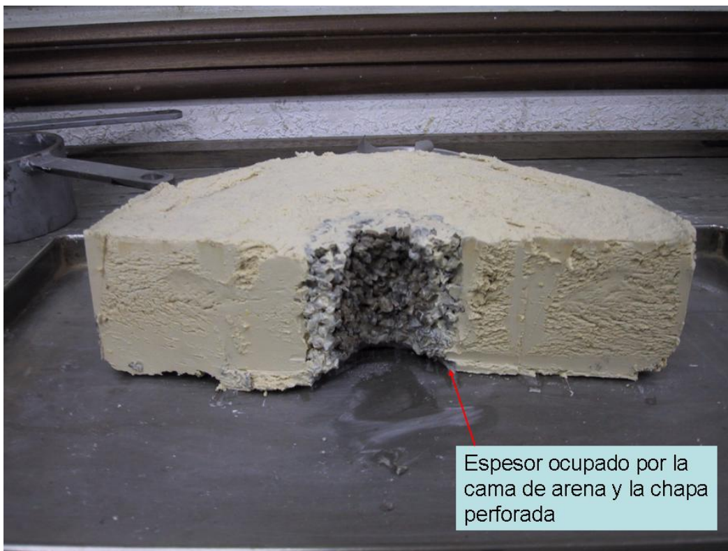
Figura E.17. Conjuntos suelo-columna después de finalizado el ensayo. N = 4 . Deformación de la columna.
