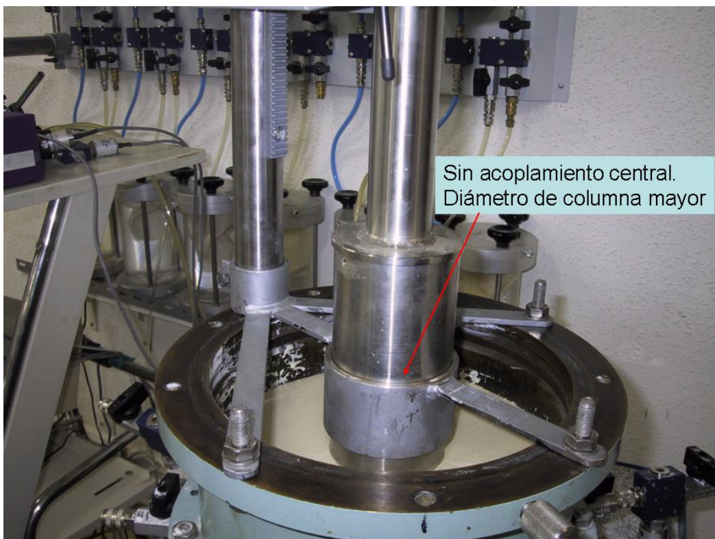
Figura E.13. Perforado de la columna durante un ensayo con N = 3
