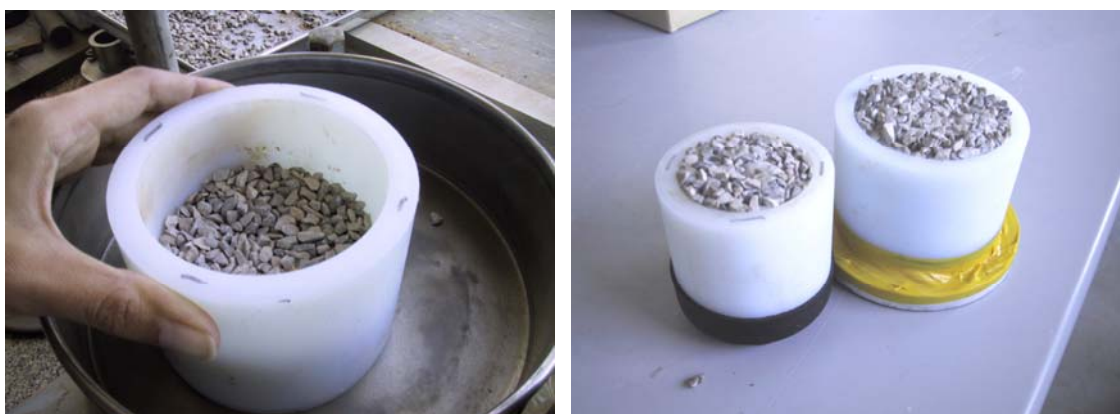
Figura E.11. Proceso de compactación de la columna durante su construcción. Columnas fabricadas preparadas para la congelación.
