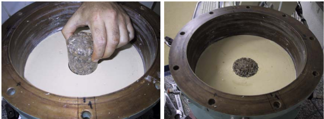
Figura E.15. Proceso de colocación de la columna. Conjunto suelo columna tras el descongelado de ésta última.
