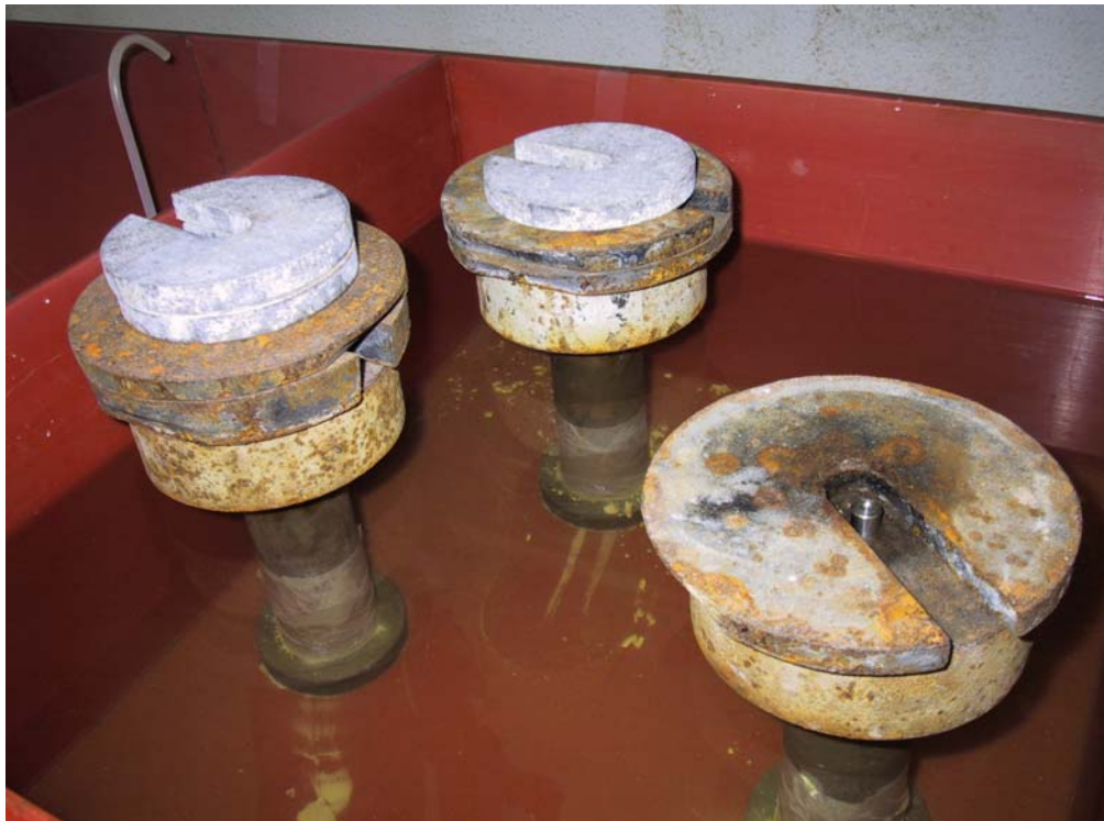
Figura E.3. Fabricación sumergida de las probetas mediante la aplicación de la carga deseada
