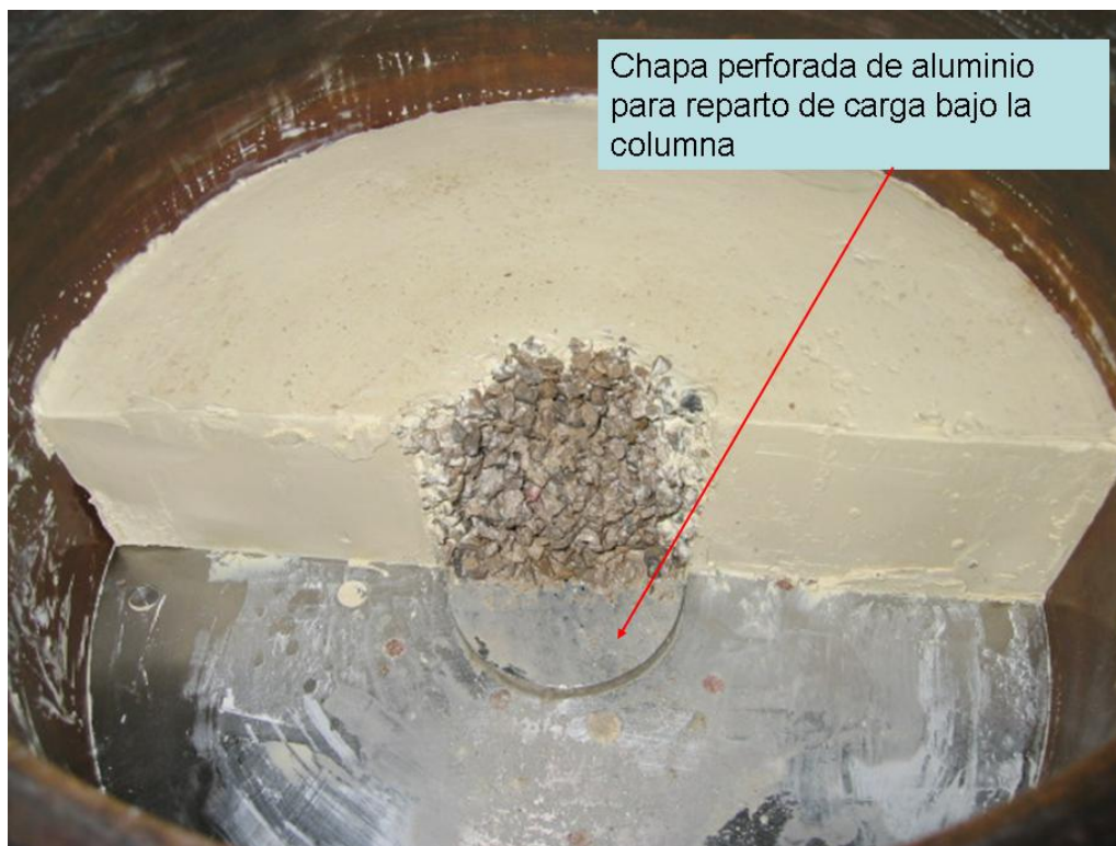
Figura E.16. Muestra al final del ensayo con geometría N = 4
