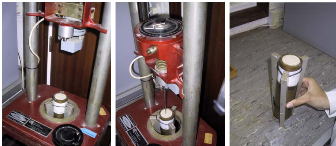
Figura E.4. Ensayo de Molinete de las probetas de caolín C-301 fabricadas
