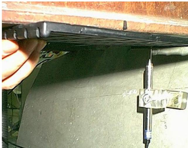
**Figura 4.4.** *Retirada de la placa de asiento en el ensayo de fuerza de apriete*
