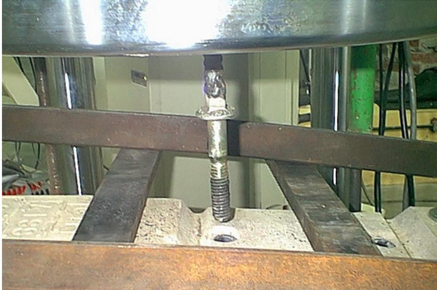
**Figura 4.8.** *Dispositivo empleado en el ensayo de carga vertical, vista lateral (después de la extracción)*
