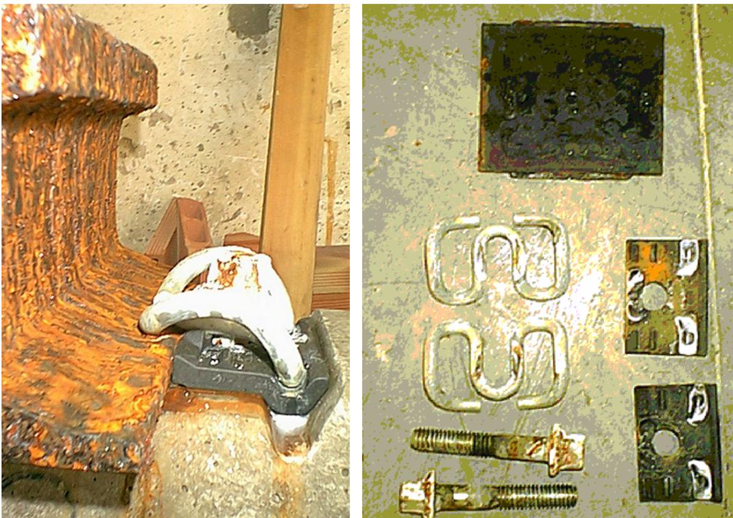
**Figura 4.46.** *Resultado del ensayo de condiciones adversas climáticas*
