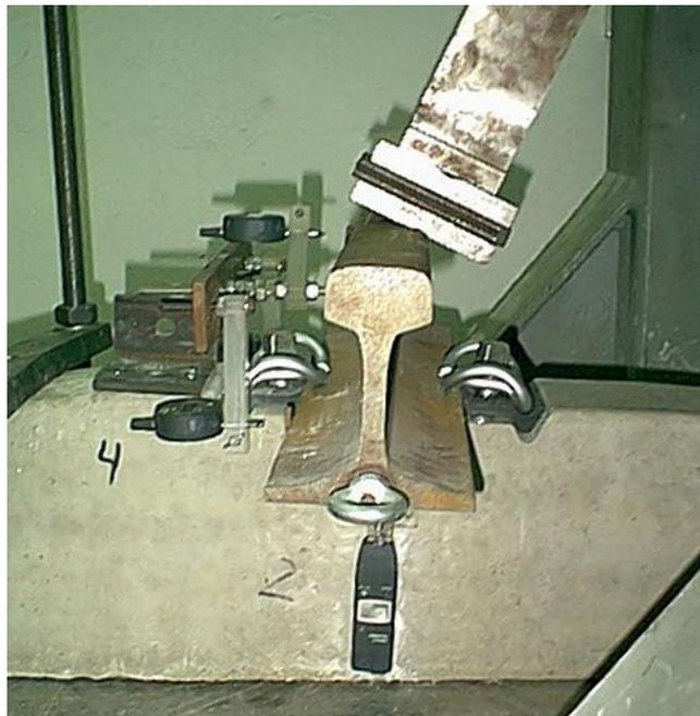
**Figura 4.37.** *Utillaje empleado para el ensayo dinámico*
