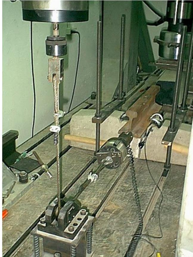
**Figura 4.22.** *Dispositivo empleado para la realización del ensayo de resistencia longitudinal*
