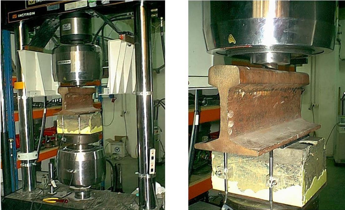
**Figura 4.10.** *Dispositivo empleado para la realización de los ensayos de rigidez vertical estática*
