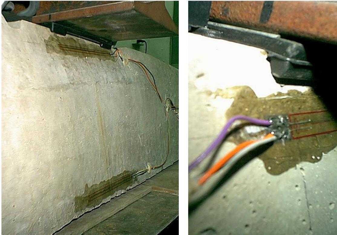
**Figura 4.19.** *Detalle de la colocación de las galgas extensométricas*
