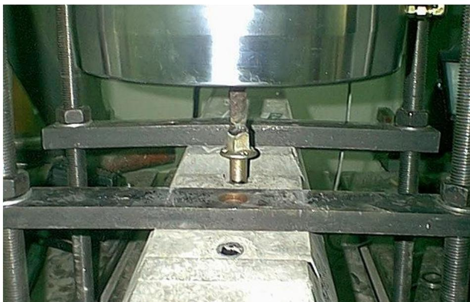
**Figura 4.7.** *Dispositivo empleado en el ensayo de carga vertical, vista frontal (antes de la extracción)*
