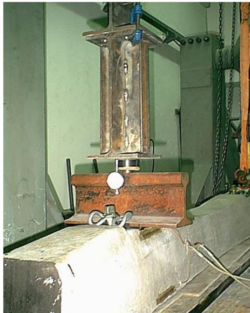
**Figura 4.18.** *Dispositivo empleado para la realización del ensayo de atenuación de impactos*
