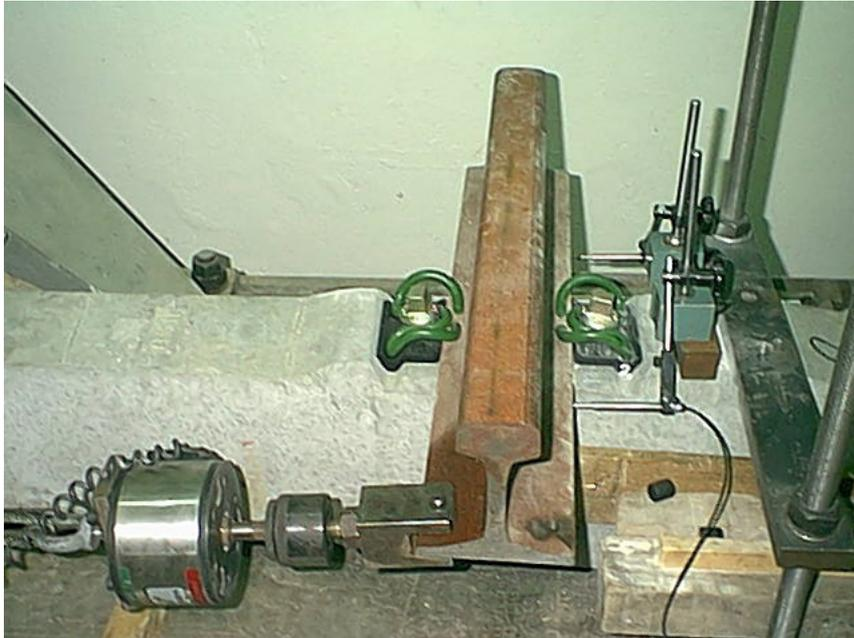
**Figura 4.29.** *Colocación de la célula de carga auxiliar*
