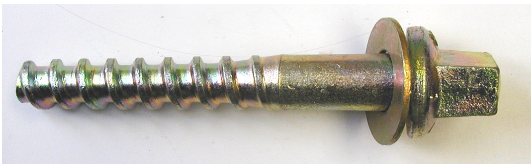
Figura 5.8. Aspecto del tirafondo del anclaje GS
