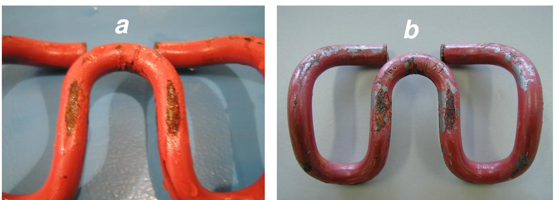
**Figura 6.55.** Aspecto del clip B usado tras 168 horas (a) y tras 300 horas (b)
