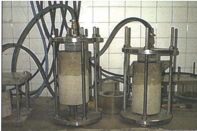
**Figura 6.41.** *Equipo empleado para obtener la profundidad de penetración*
