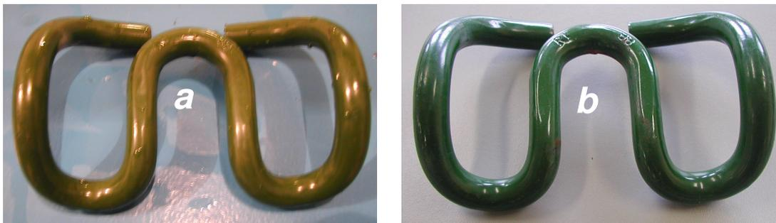
**Figura 6.57.** Aspecto del clip A nuevo tras 168 horas (a) y tras 300 horas (b)
