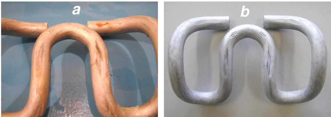
**Figura 6.53.** Aspecto del clip C usado tras 168 horas (a) y tras 300 horas (b)
