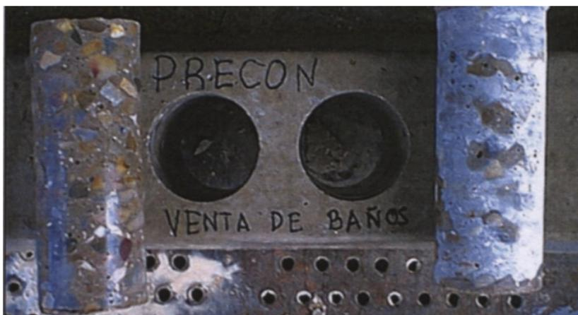
**Figura 6.38.** *Aspecto de la traviesa y los testigos tras su extracción*
