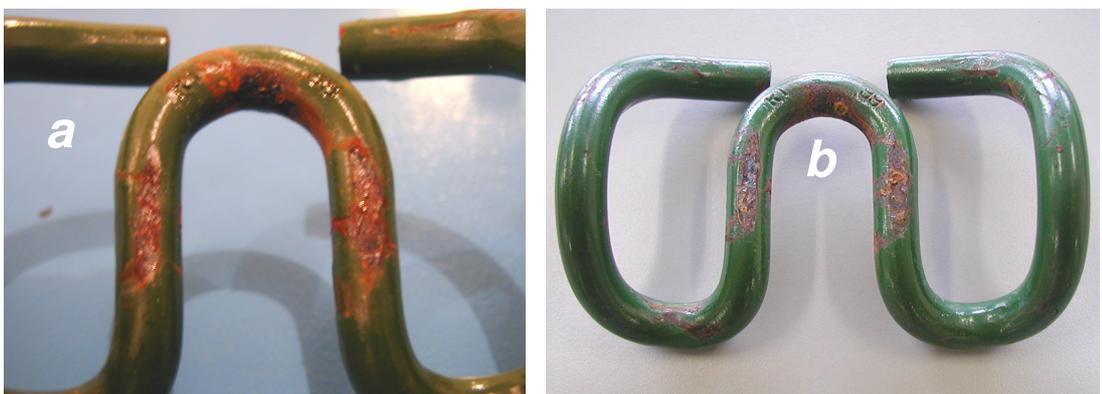
**Figura 6.54.** Aspecto del clip A usado tras 168 horas (a) y tras 300 horas (b)
