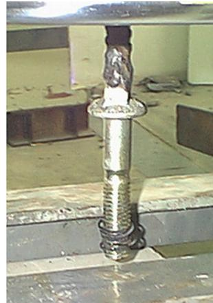
**Figura 6.27.** Comportamiento del anclaje VAPE en extracción y rotura
