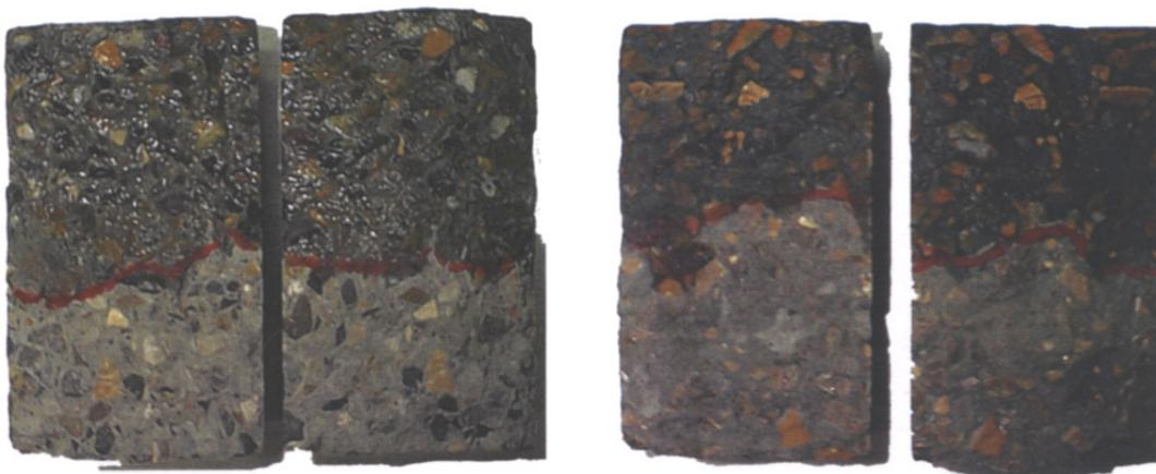
**Figura 6.42.** *Aspecto de la rotura de la probeta tras el ensayo brasileño*
