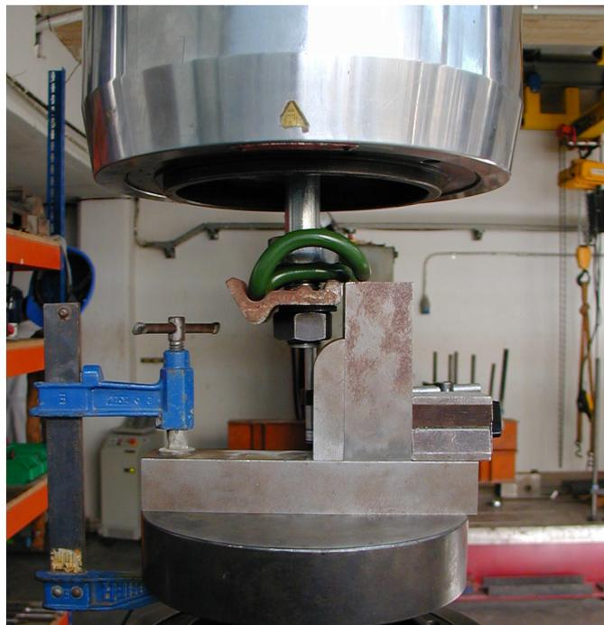
**Figura 6.74.** *Dispositivo empleado para los ensayos mecánicos de los clips*
