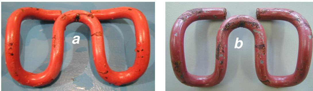
**Figura 6.58.** Aspecto del clip B nuevo tras 168 horas (a) y tras 300 horas (b)
