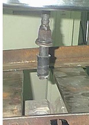
**Figura 6.26.** Comportamiento del anclaje SDÜ PA en extracción y rotura
