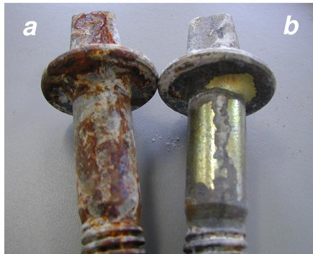
**Figura 6.51.** Aspecto de dos tornillos tras 300 horas de ensayo con corrosión generalizada (a) y fuerte (b)
