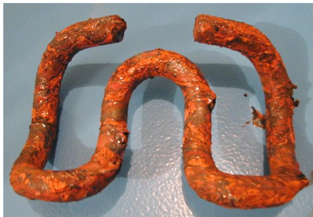
**Figura 6.52.** Aspecto del clip A sin esmalte tras 168 horas de ensayo
