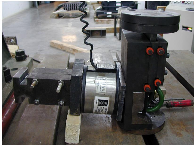
**Figura 8.26.-** Dispositivo empleado para la medida de la fuerza en el tornillo
