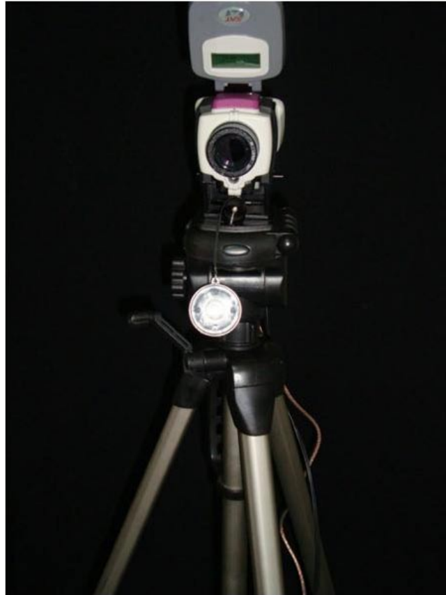
Figura 1. Aparato de termografía infrarroja: cámara de video, acoplada a un sistema de software específico.
