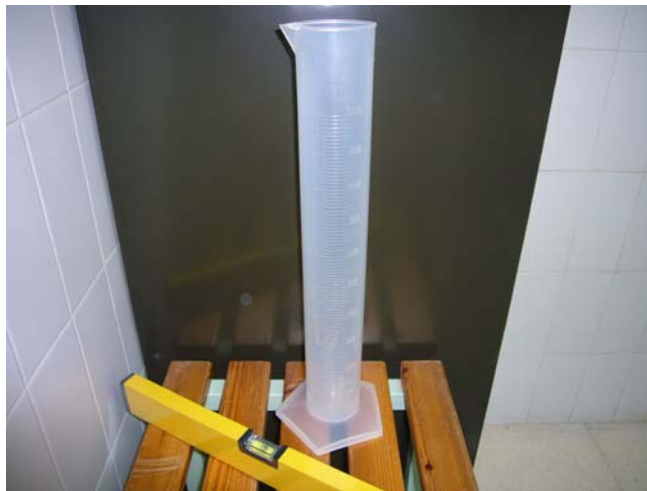
Figura 11. Superficie nivelada donde se apoya la probeta.
