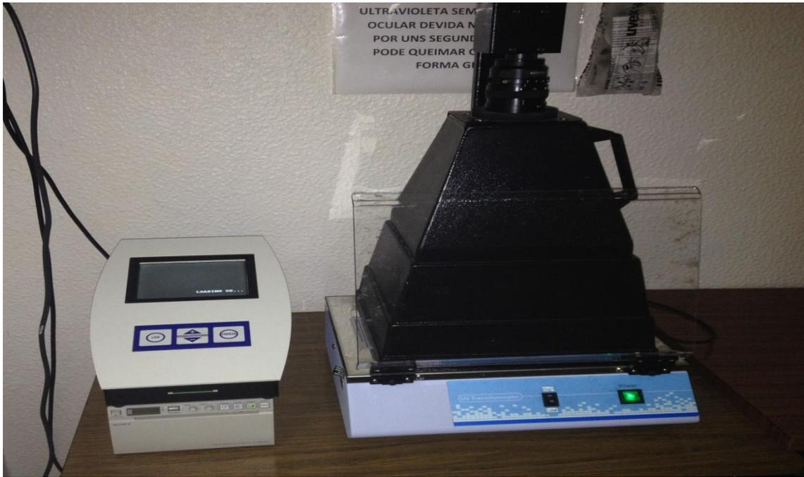
Figura 19: Sala específica en el Instituto Superior de Ciências da Saúde Egas Moniz, para visualización de geles a través de un transiluminador de luz UV y un sistema digital para documentación de los mismos.
