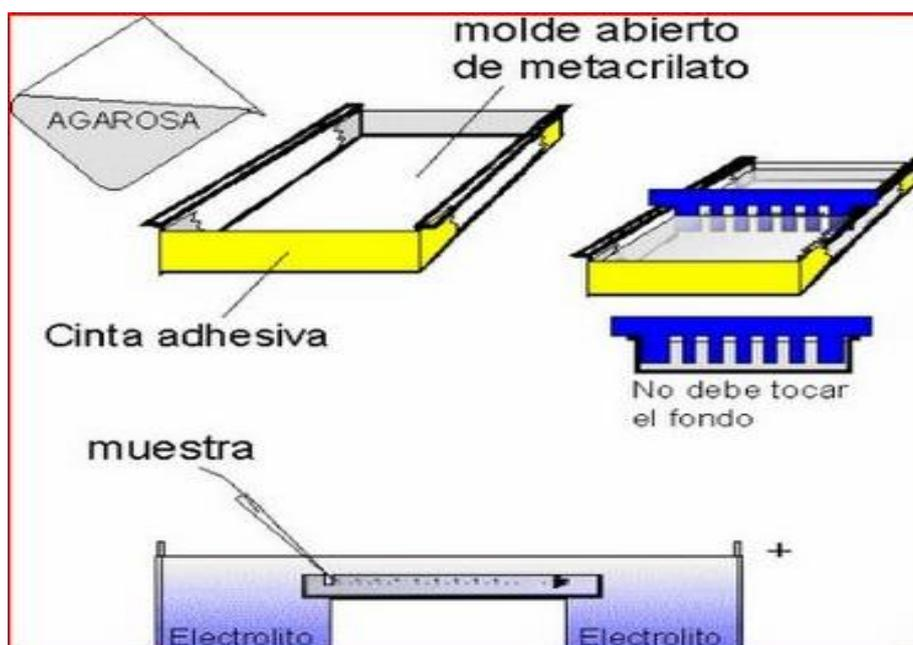
Figura 7: Colocación de la muestra para electroforesis en gel de agarosa<sup>75</sup>
