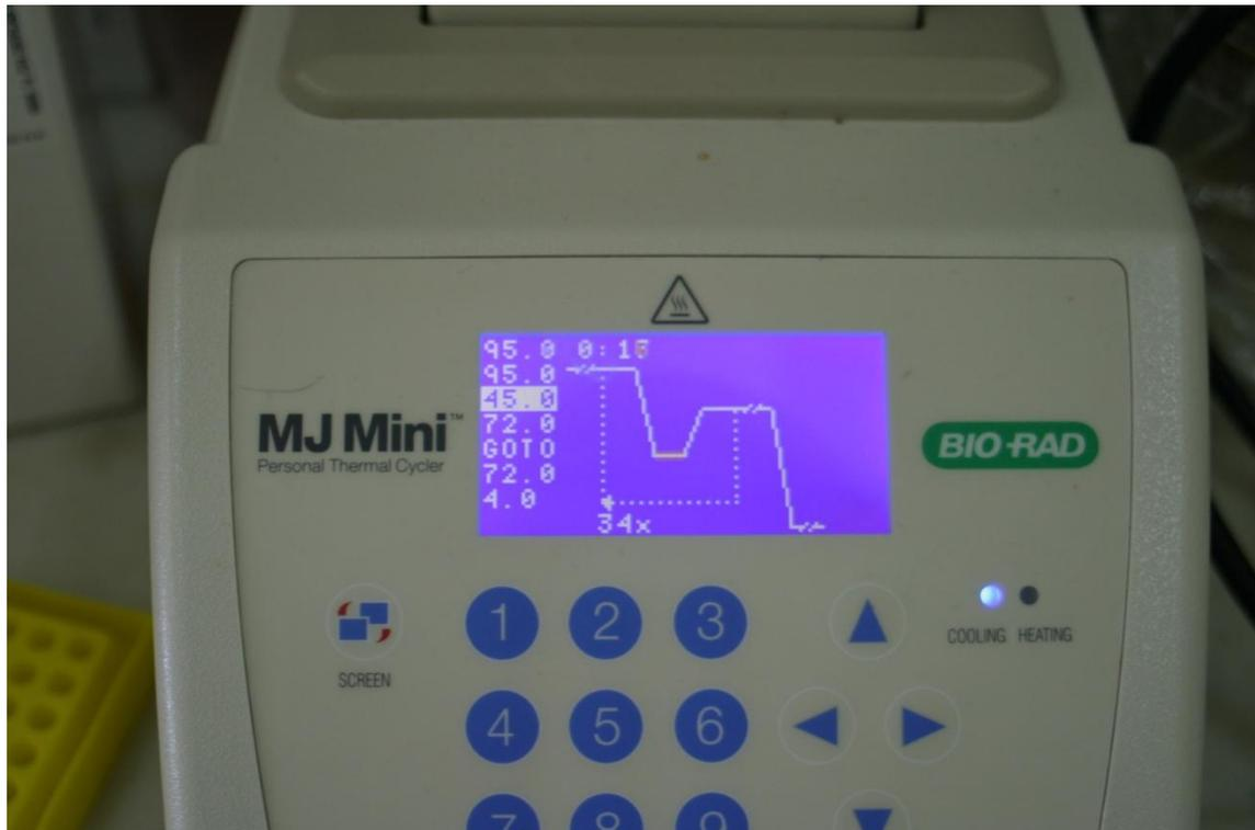
Figura 12: Ciclos de la PCR, para amplificación de ADN con una temperatura de hibridación de 45°C.
