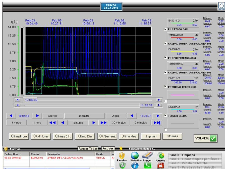
Figura VI.11 Representación del pH con el programa SCADA
