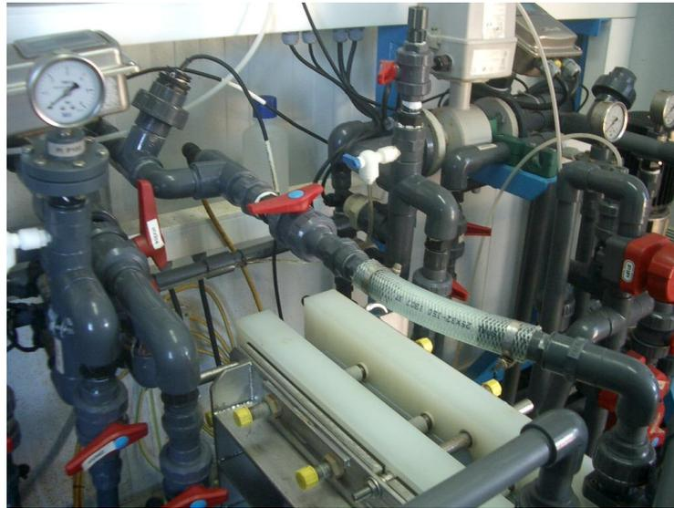
Figura VI.8 Diseño de la salida de hidrogeno
