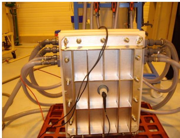
Figura II.14 Stack de membranas
