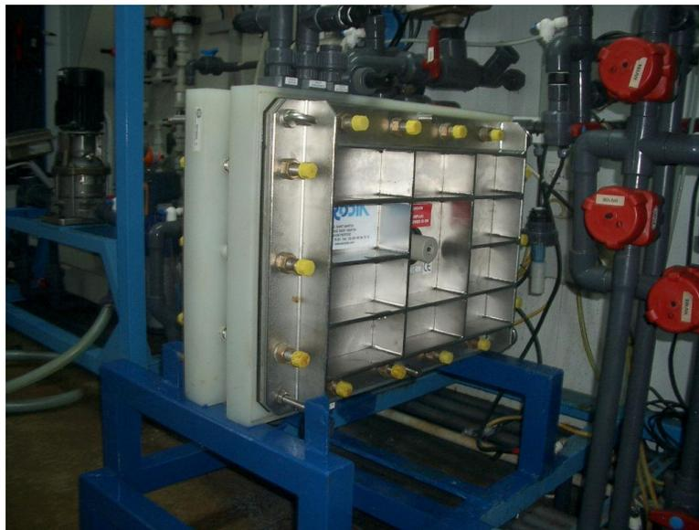
Figura VI.7 Posición del stack después del nuevo montaje con la salida de hidrogeno en la parte superior
