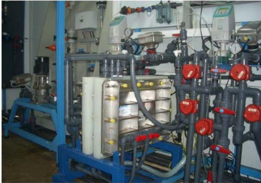
Figura 7.6 Visión global del stack y de las tuberías que conforman los diferentes circuitos en la planta piloto
