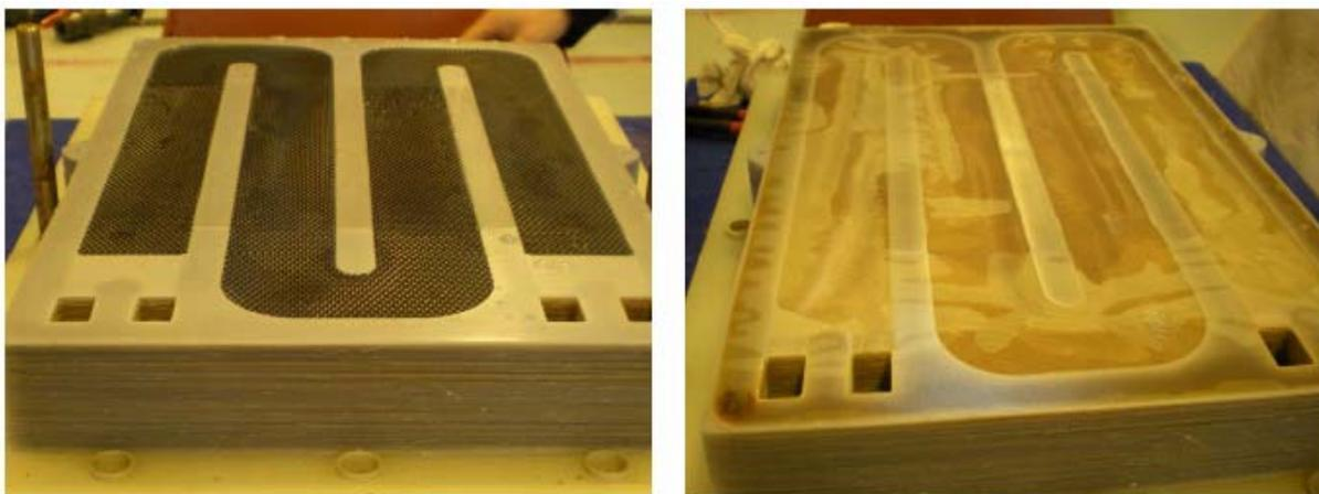
Figura 7.3 Detalle de la disposición de las membranas y los espaciadores dentro del stack de ED (Izquierda: espaciador en la parte superior del conjunto; Derecha: membrana de intercambio iónico en la parte superior del conjunto)
