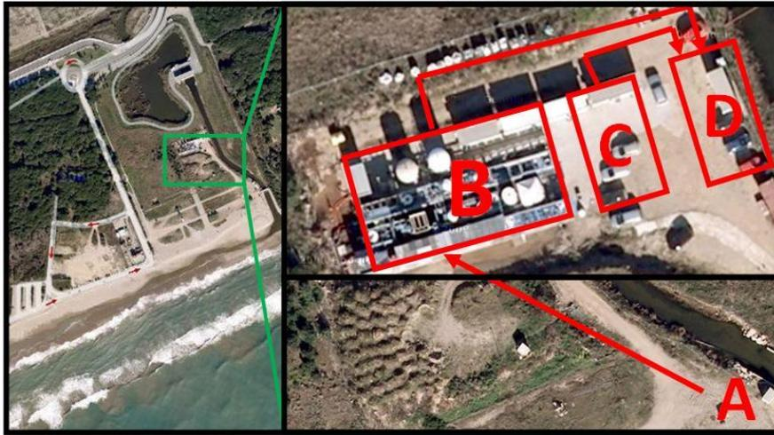
Figura II.2 Centro de investigación en el Prat de Llobregat (A- Captación; B- Planta Piloto de Degremont; C- Planta Piloto de DOW; D- Planta Piloto de Electrodiálisis)
