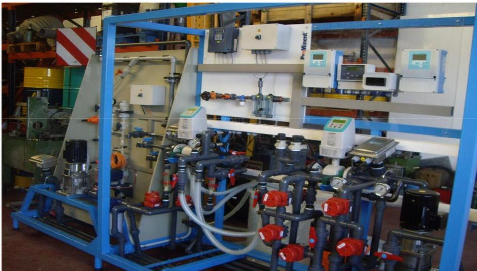
Figura III.2 Construcción del panel de ED, Alicante, 9 de Marzo 2009.
