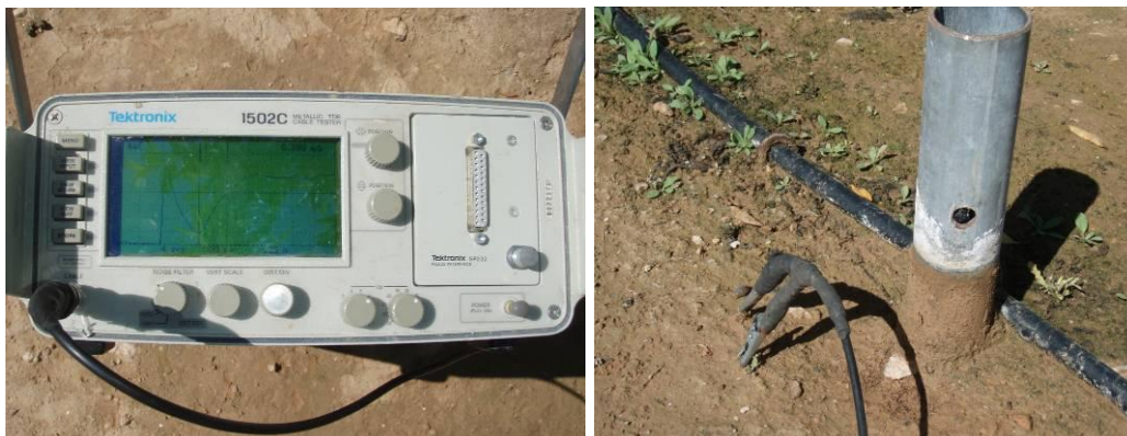
Fotografía 5. 3. Equipo TDR (Izda.) y detalle de las pinzas de cocodrilo (Dcha.).
