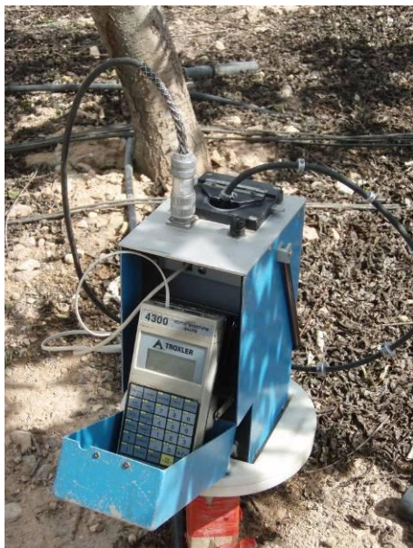
Fotografía 5. 2. Sonda de neutrones utilizada para la medida de la humedad del suelo.
