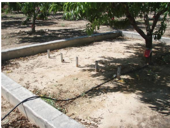
Fotografía 5. 4. Disposición de los tubos de acceso de sonda de neutrones en el lisímetro.
