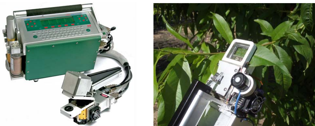
Fotografía 6. 3. Equipo de medida de intercambio gaseoso LICOR LI 6400 (Izda.) y medida sobre hoja (Dcha.).
