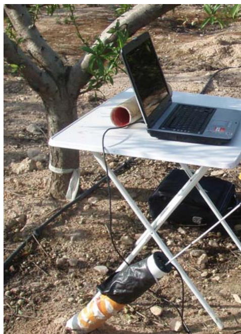
Fotografía 6. 5. Detalle del escáner circular y minirrizotrófono (Dcha.) y equipo completo para la medida de dinámica de raíces en campo (Izda.).
