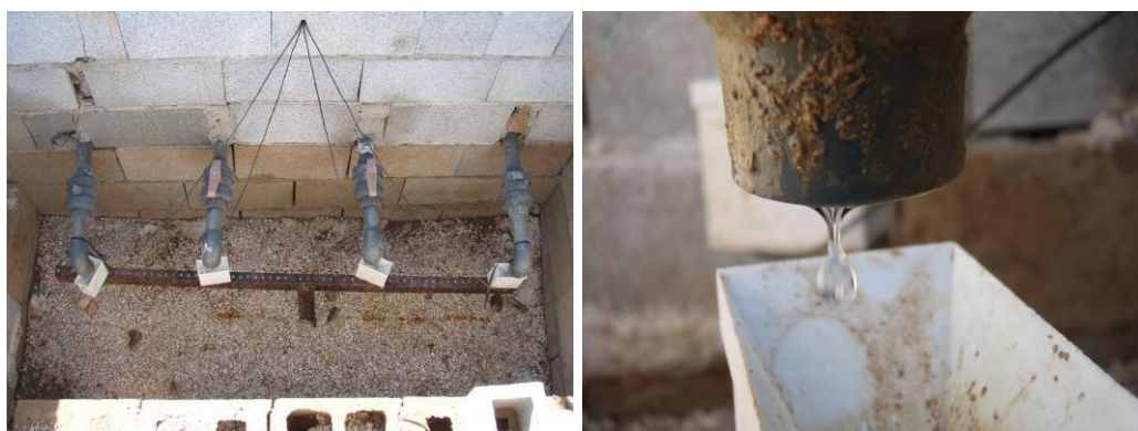
Fotografía 5. 7. Tuberías de salida del agua de drenaje de los lisímetros (Izda.) y detalle del goteo de agua sobre el caudalímetro (Dcha.).
