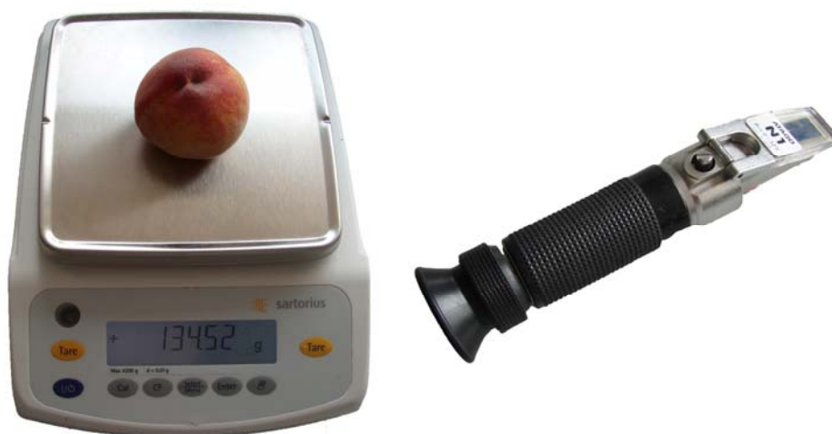
Fotografía 6. 11. Evaluación del peso fresco del fruto (Izda.) y refractómetro para la medida de los sólidos solubles (Dcha.).
