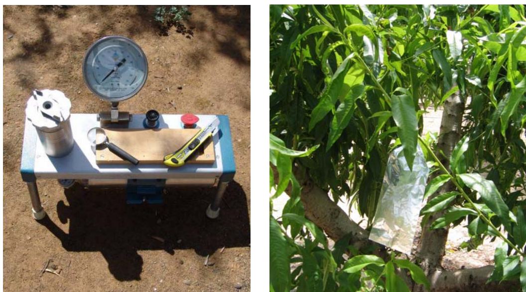
Fotografía 6. 2. Cámara de presión (Izda.) y detalle de una hoja tapada en el árbol (Dcha.).
