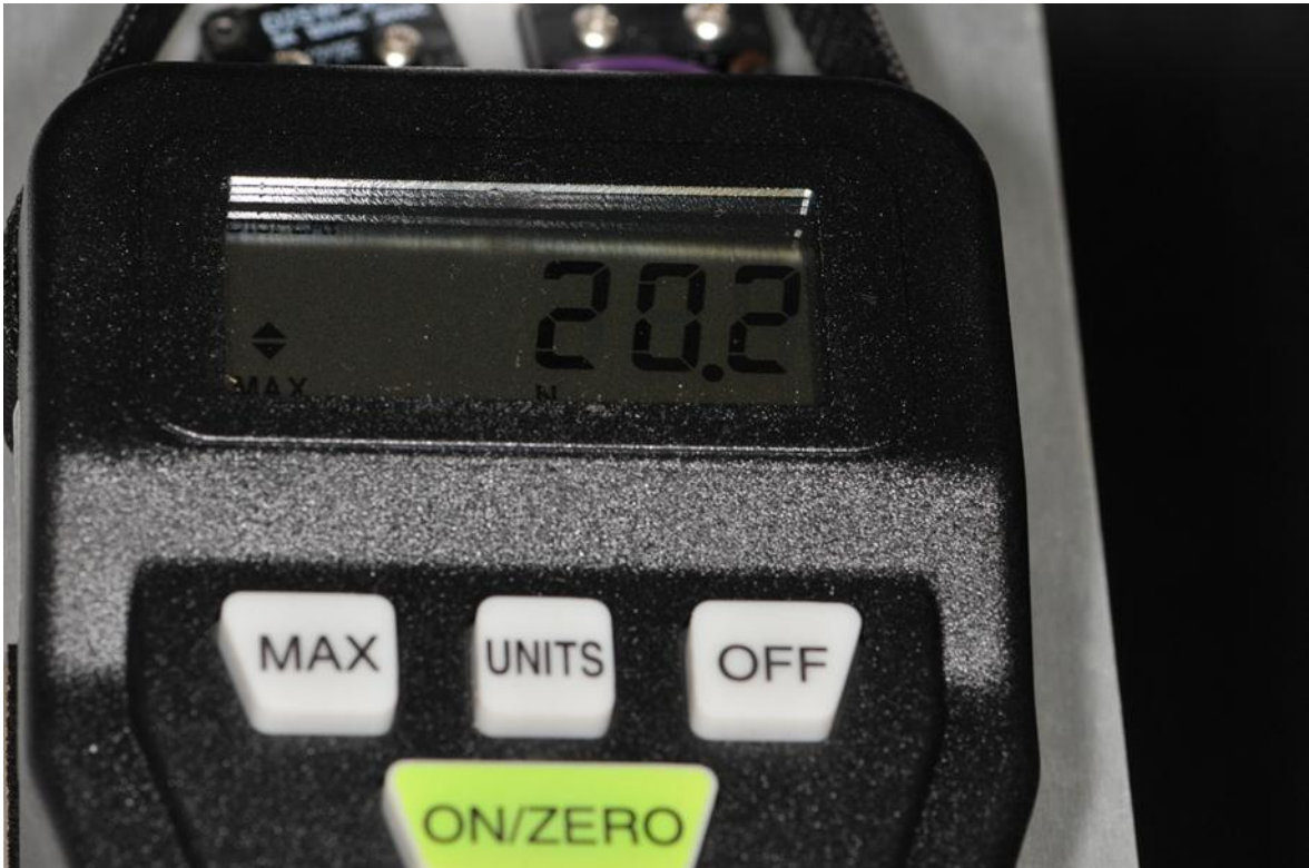
Figura 45. El sensor electrónico de la Bisco Shear Bond Tester durante el procesamiento de una de las muestras.
