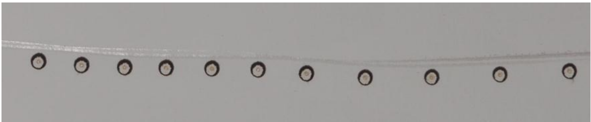
Figura 33. Muestra de los impactos del láser sobre papel termográfico
