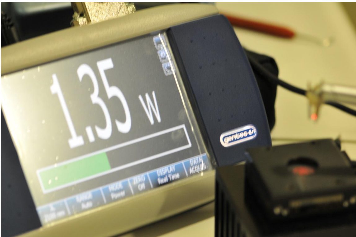
Figura 30. Pantalla donde se registra progresivamente la energía que el laser deposita en el receptor, expresada en vatios. Se probaron varias potencias de pantalla hasta conseguir la potencia real de trabajo deseada. En la imagen, potencia calibrada para una potencia en pantalla de 3W en nuestra unidad
