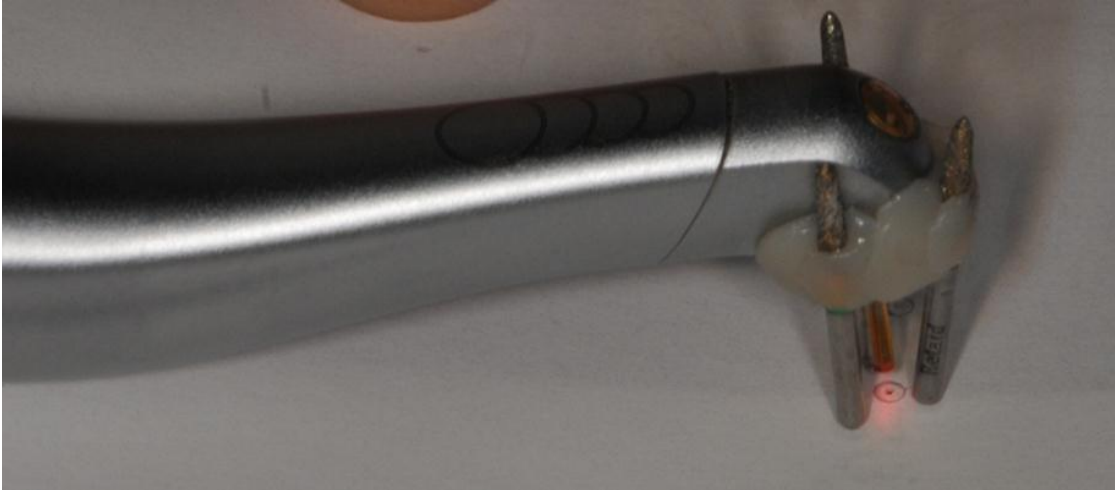
Figura 34. Comprobación del diámetro del impacto y de la distancia focal
