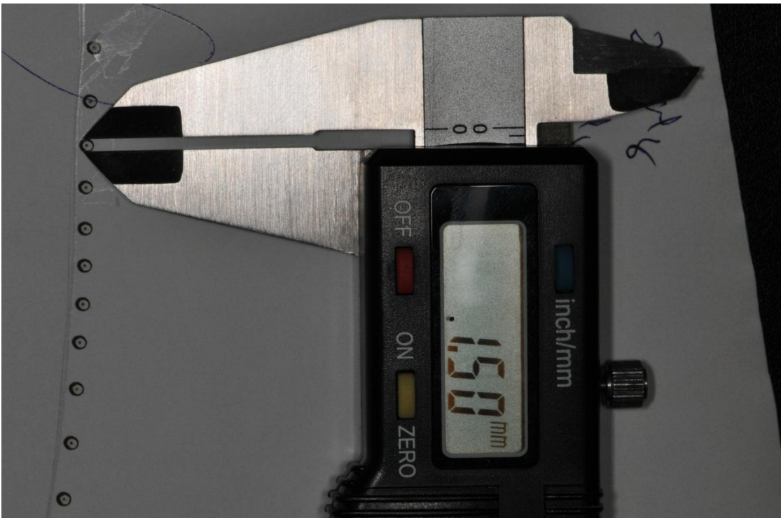
Figura 35. Medición del diámetro del impacto mediante pie de rey electrónico. Se utilizaron lupas
