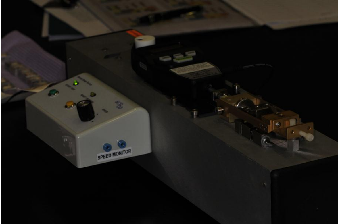
Figura 44. Detalle del control de la velocidad de avance de la máquina Bisco Shear Bond Tester
