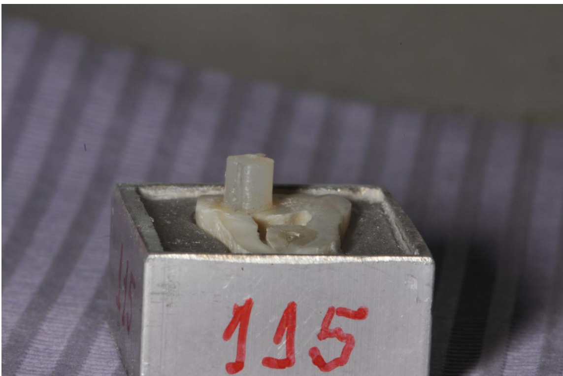
Figura 38. Cilindro de resina sobre la superficie de dentina impregnada por el adhesivo en una de las muestras.
