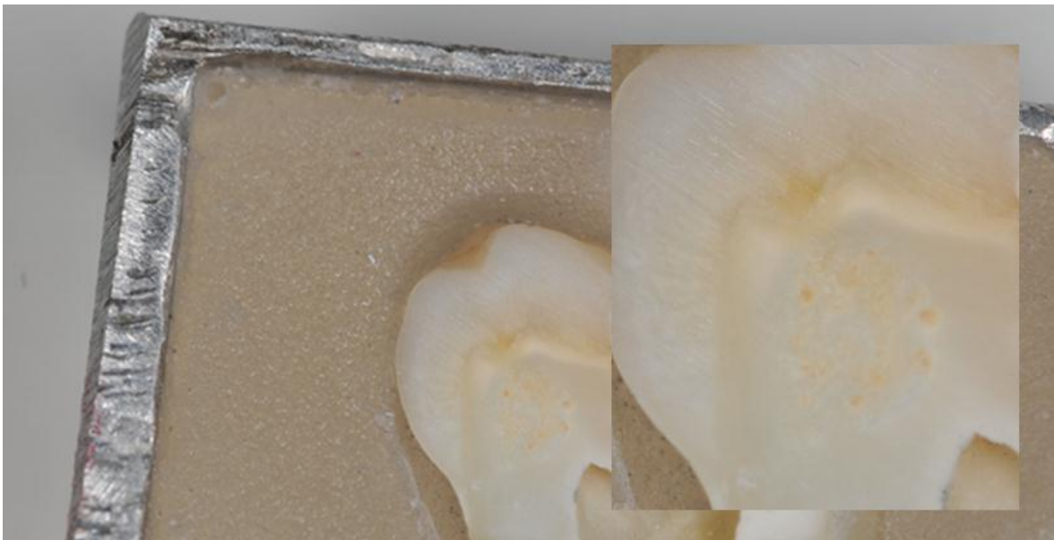
Figura 25. Muestra irradiada en la zona de la dentina. Detalle de los cambios provocados por la irradiación
