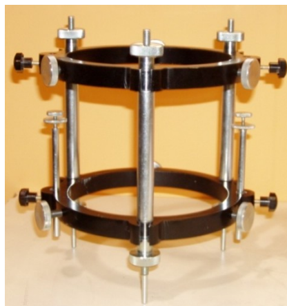
Figura 3.15 Accesorios empleados en el ensayo de módulo de elasticidad.
