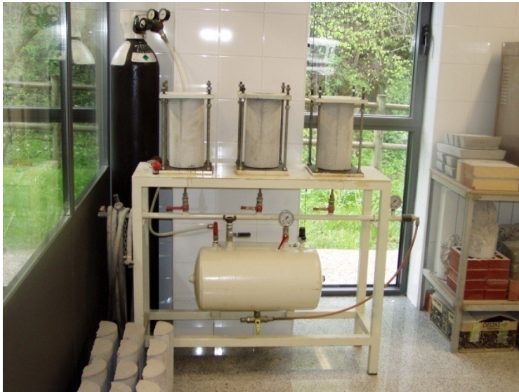
Figura 3.19 Ensayo de penetración de agua bajo presión.
