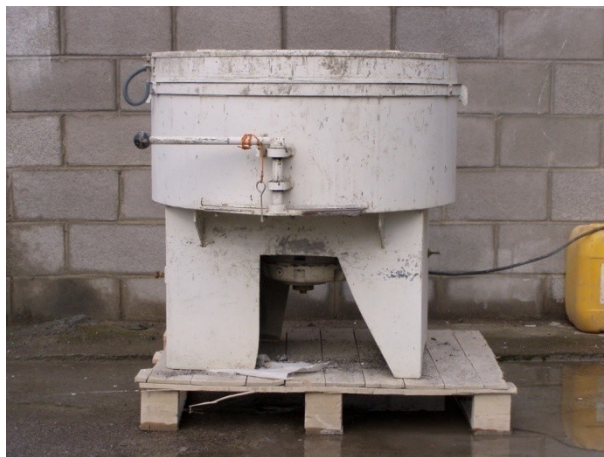
Figura 3.9 Amasadora empleada en la fabricación del hormigón.
