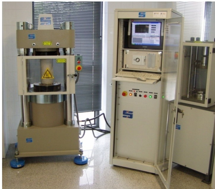
Figura 3.14 Ensayo de resistencia a compresión.
