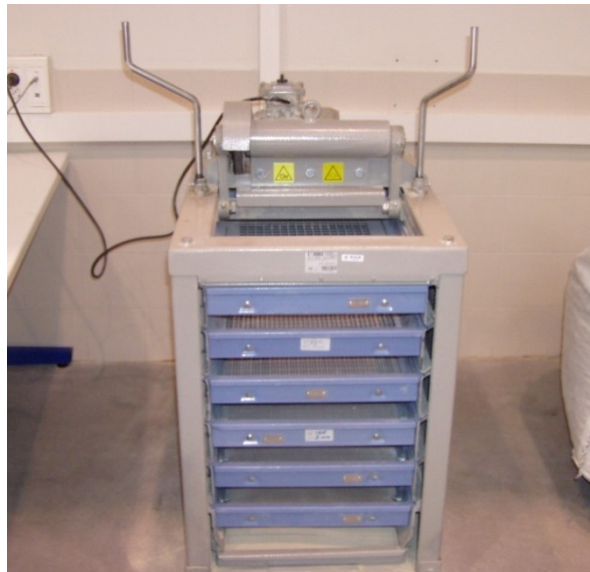
Figura 3.8 Tamizadora empleada en el cribado de los áridos reciclados.
