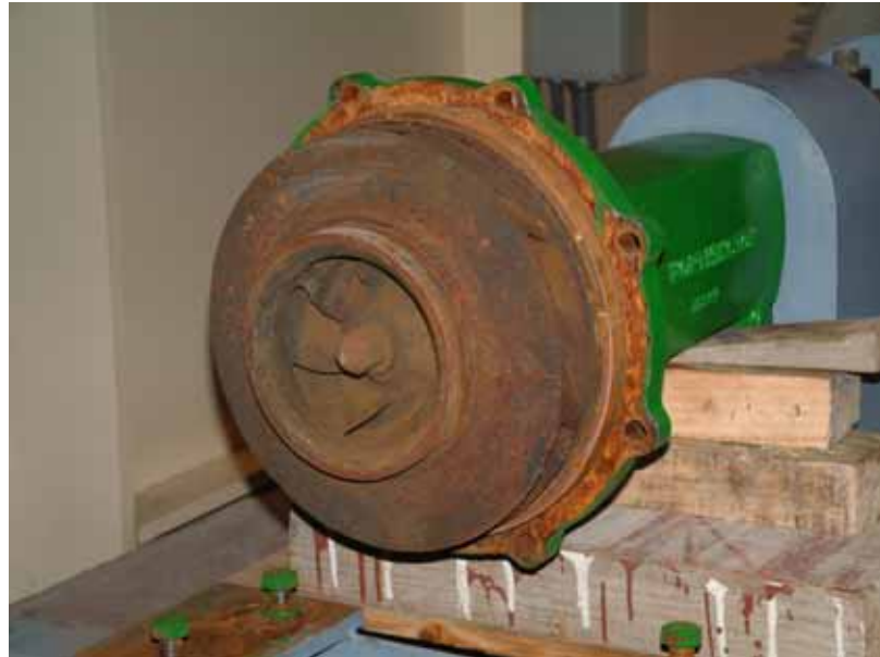
Fig. 4-4. Detalle de Bomba sin voluta, con el rodete acoplado.
