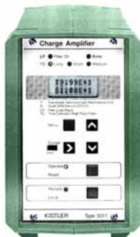
Fig. 4-18. Amplificador de carga KISTLER 5011.
