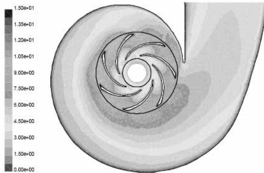
Fig. 2-12. Contornos de velocidad absoluta (escala en m/s) en una bomba centrífuga operando a caudal nominal, según cálculo CFD para una bomba 2D, González (2000) .
