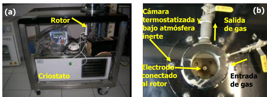
Figura 5.1.- (a) Imagen de la cámara de polimerización con el criostato y el rotor de velocidad controlada; (b) vista superior del dispositivo utilizado.
