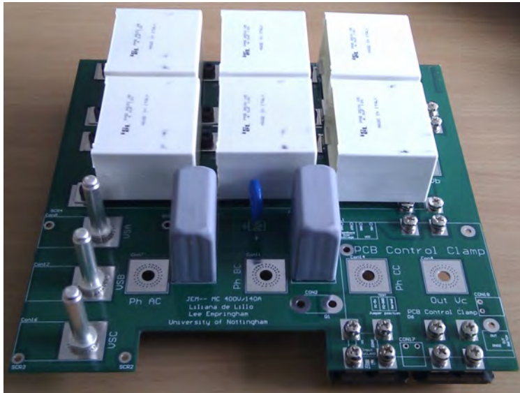
Figura A.10: Placa Power plane
