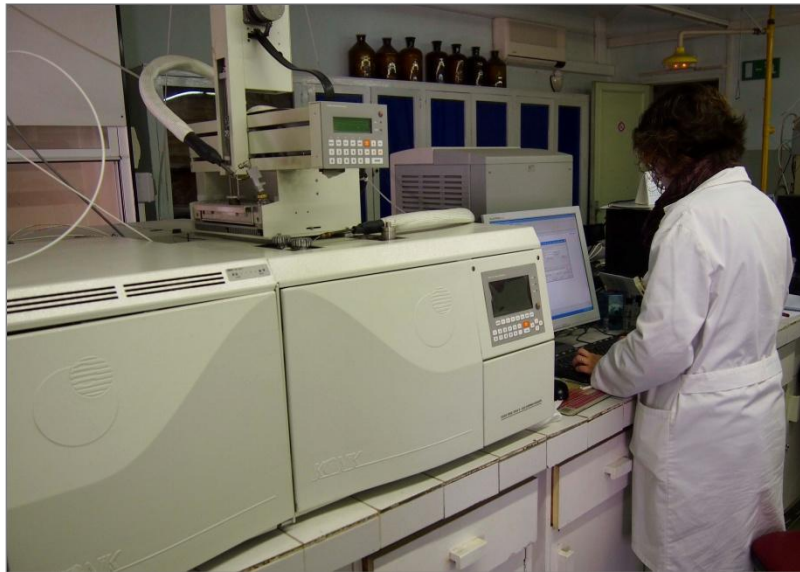
Imatge 6.1 Cromatògraf de gasos Konik HRGC 4000B-MS Q12
