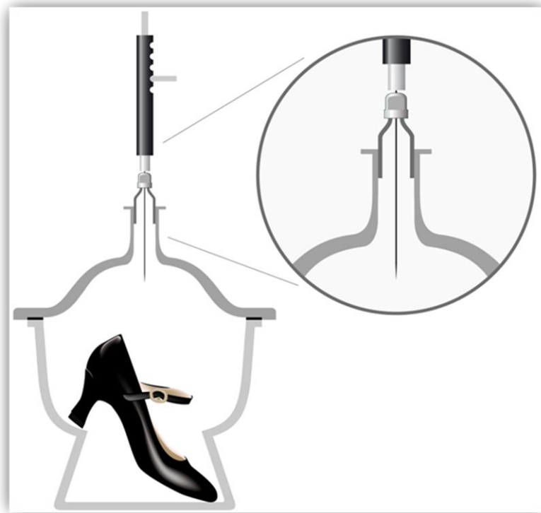
Figura 5.3 Esquema del procés d'extracció del DMFU amb SPME
