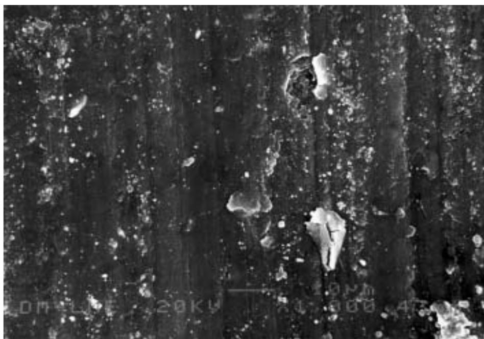
Figura 72. Detalle del desgaste abrasivo.
