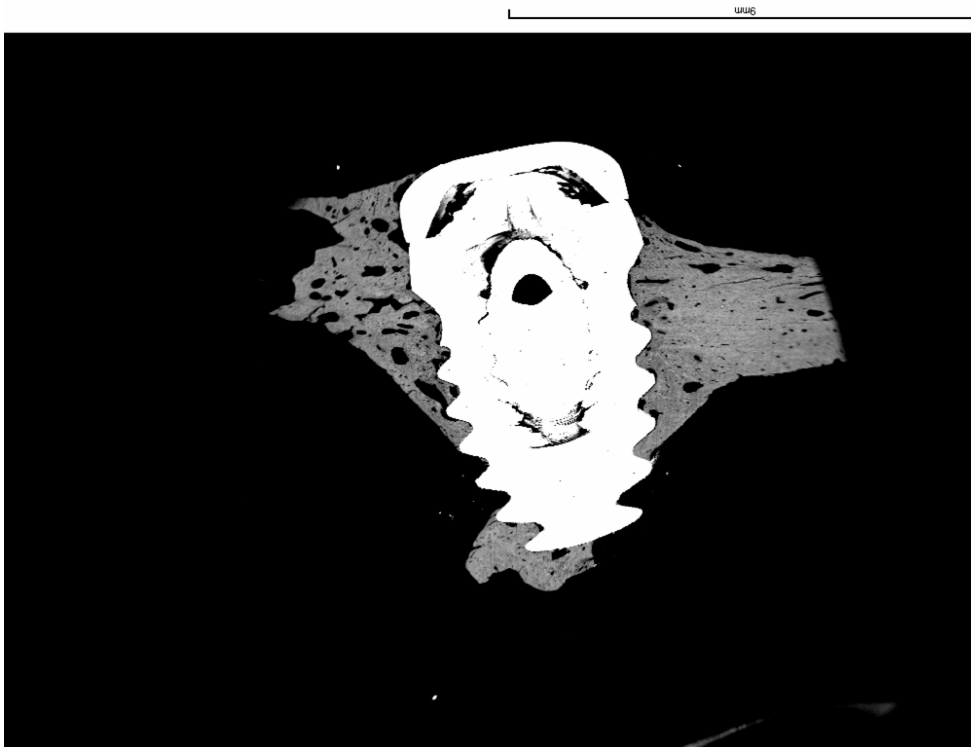
Figura 89. Muestra 13t. Imagen de MEB utilizada para el estudio del porcentaje de contacto del implante procedente de la tibia del conejo n°13.
