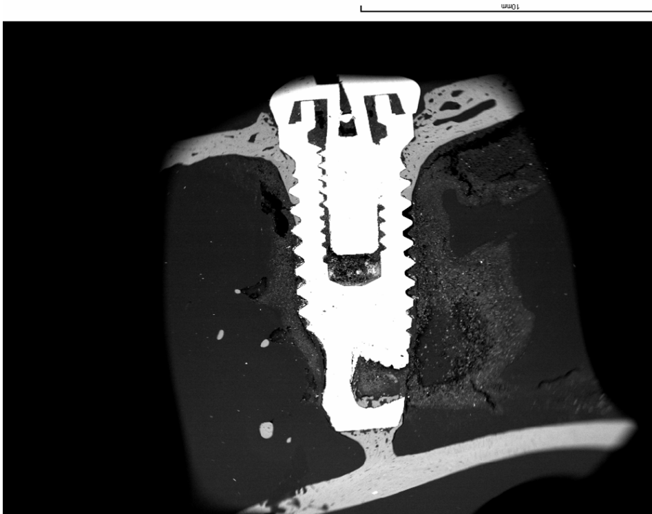
Figura 84. Muestra 11f .Imagen de MEB utilizada para el estudio del porcentaje de contacto del implante procedente del fémur del conejo n°11.
