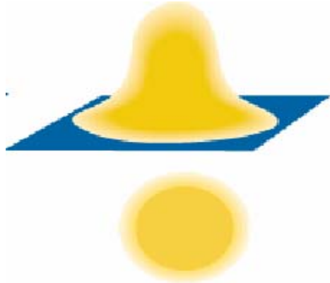
Figura 14. Distribución Gaussiana del haz de láser (TEM 00).
