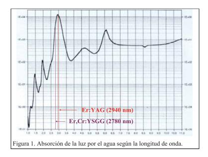
En la figura 1 podemos ver la correspondencia de las longitudes de onda del láser de Er:YAG y del láser de Er,Cr:YSGG en relación con la absorción por el agua.
