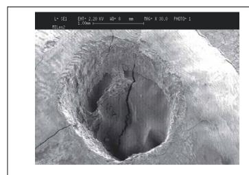
**Figura 17.** Detalle de un cráter de 2 mm de diámetro, perforando el esmalte.
