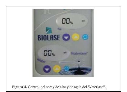
En la figura 4 podemos observar la parte del panel de control que corresponde a los ajustes de los volúmenes del spray. Su ajuste en % permite una exactitud, repetible, en los procedimientos en que se utilice.
