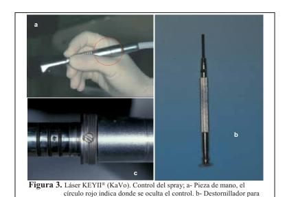
En la figura 3 podemos ver el sistema de control del spray de agua del láser de Er:YAG KEYII<sup>®</sup> (KaVo, Biberach, Alemania). En la figura 3a vemos la pieza de mano con ventana de emisión, y en un círculo amarillo se señala donde se esconde el tornillo de regulación del volumen del spray. Para acceder a él, debe desenroscarse el protector, y con la ayuda de un destornillador (Figura 3b) mover el tornillo de control (Figura 3c) hasta encontrar el volumen deseado.
