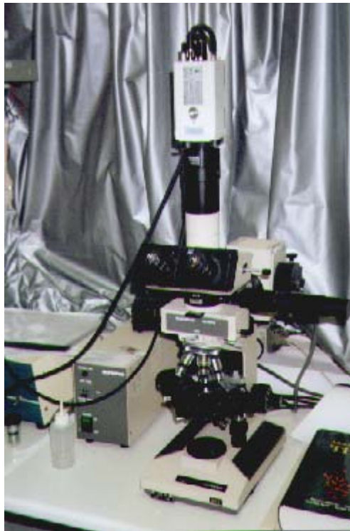
Figura nº 27 : Microscopi òptic connectat al sistema de digitalització d'imatges. Departament d'Anatomia Patològica de l'Hospital Clínic de Barcelona.
