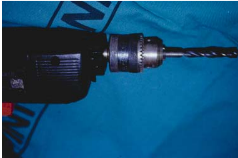
Figura nº 12 : Broca de 6mm de diàmetre. L'extrem amb punxa facilita el correcte centrat durant la perforació.
