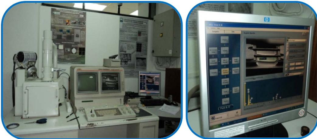
*Figura IV. 3 Set-up de medidas con microscopio electrónico (SEM)
