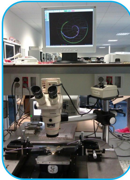
*Figura V. 3 Equipo de Medida del Laboratorio, En primer plano el microscopio de la estación de sondas.*
