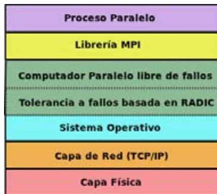
Figura 5.1: Computador paralelo libre de fallos para aplicaciones MPI
