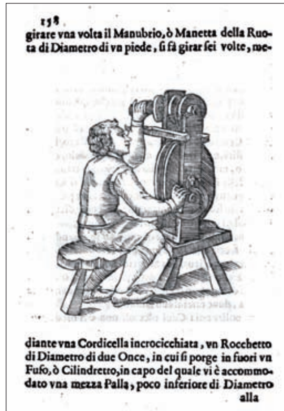
Grabado en el libro L'occhiale all'occhio, dioptrica practica que representa un torno para la fabricación de cristales refractivos.
