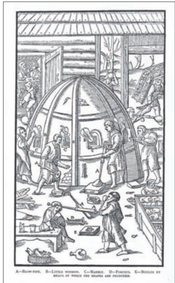
Grabado en el libro De Re metallica , uno de los primeros grabados que representan la fabricación de vidrio en un taller.
