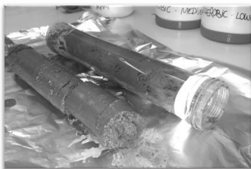
Figura 8.6. Detall de la partició de la columna post incubació en tres trams.
