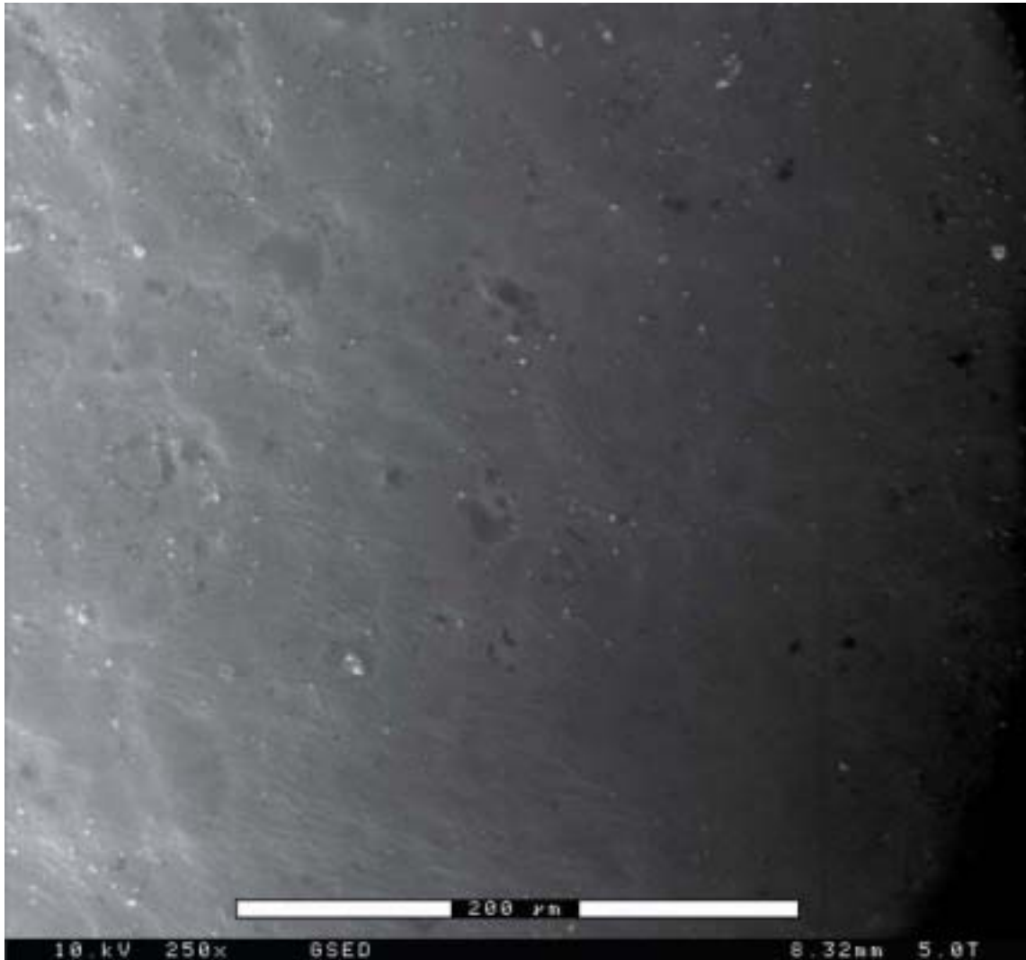
Fig. 33. Superfície en estat fresc. S'observa una extensió uniforme sense fenedures ni llacunes. Algunes imatges poden correspondre a residus o ser discretes depressions a la superfície.
