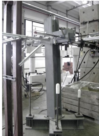
Figura 5-44 Pilar metálico usado en las pruebas de control de carga bidireccional
