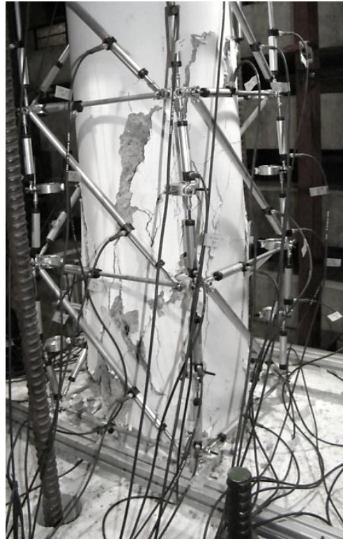
Figura 5-53 Daños en el último ciclo de carga del pilar B2-945-300-N
