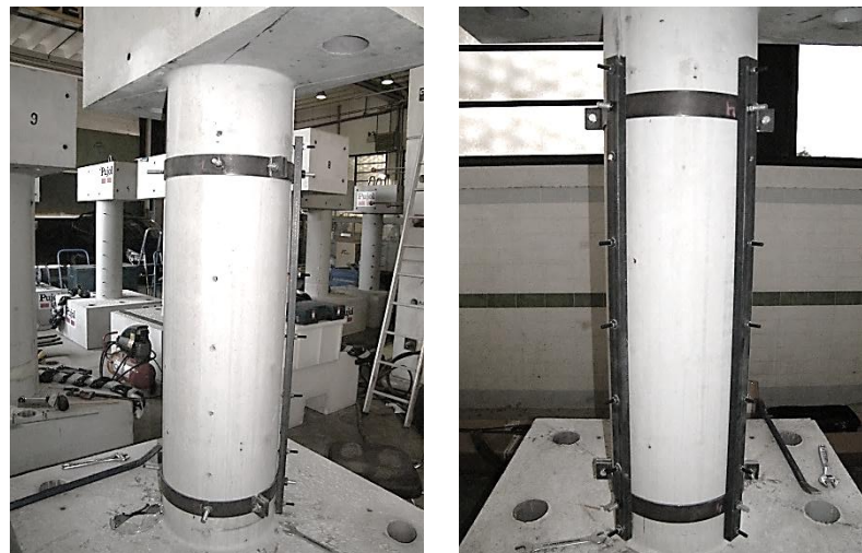
Figura 5-28 Guía de perforación para localización de elementos conectores para los potenciómetros
