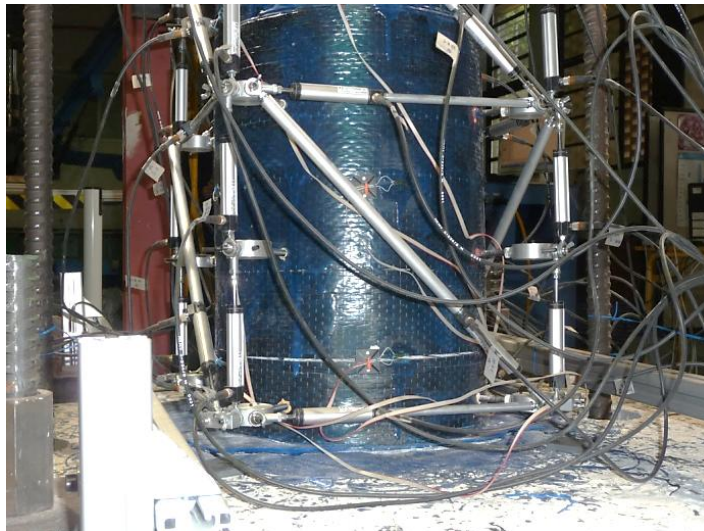
Figura 5-65 Estado de la FRP en el último ciclo de carga del pilar B9-1100-200-CFRPx6
