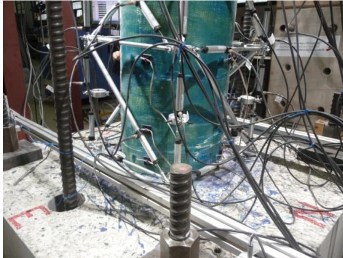
Figura 5-68 Estado del FRP en el último ciclo de carga del pilar B7-1100-200-AFRPx2
