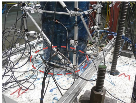
(b) Ruptura del CFRP entre 0.0 y 50mm de la base
