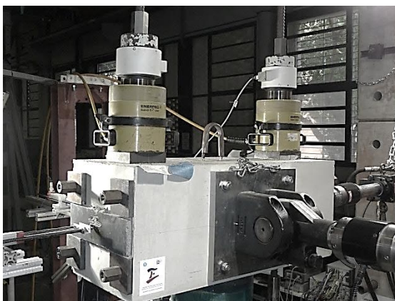
(a) Anclaje fijo en extremo superior
