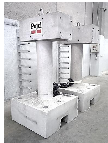
(b) Pilar desencofrado
