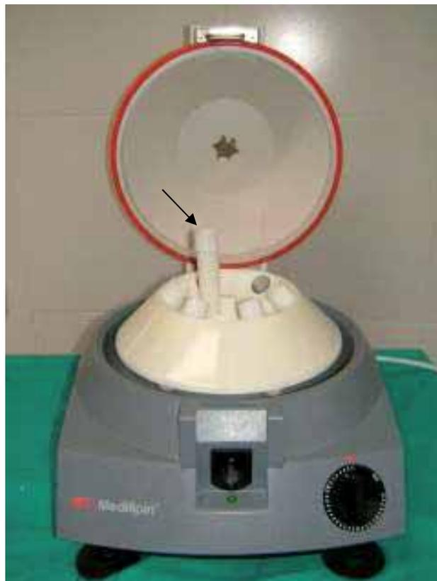
Fig. 36: Centrifuga Medilite 2581 para el decantado del material obtenido por aspiración. La flecha indica los cilindros donde se depositan las jeringas.
