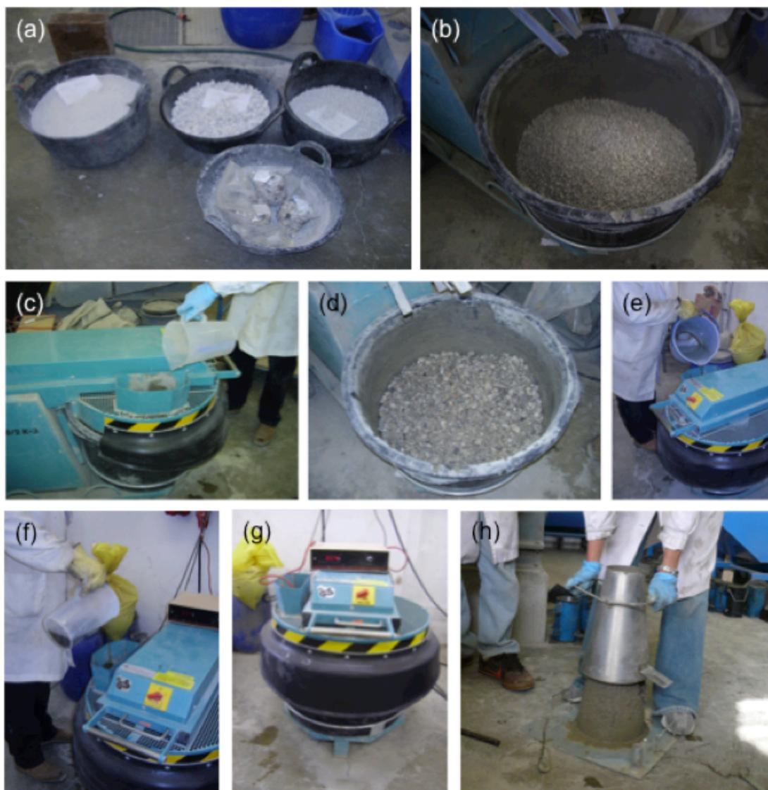
**Figura 4.13. Registros fotográficos del procedimiento de fabricación de los hormigones analizados en este estudio**
