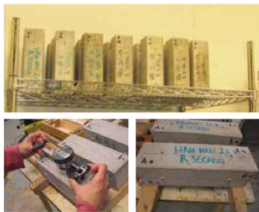
Figura 5.11. Registros fotográficos del ensayo de retracción por secado – Método Interno del Laboratorio
