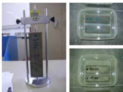
Figura 5.5. Registros fotográficos del ensayo de retracción por secado – Método UNE 83318:1994
