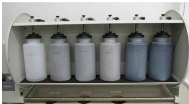
Figura 5.58. Equipo de agitación utilizado para realización de los ensayos según UNE EN 12457-4:2003
