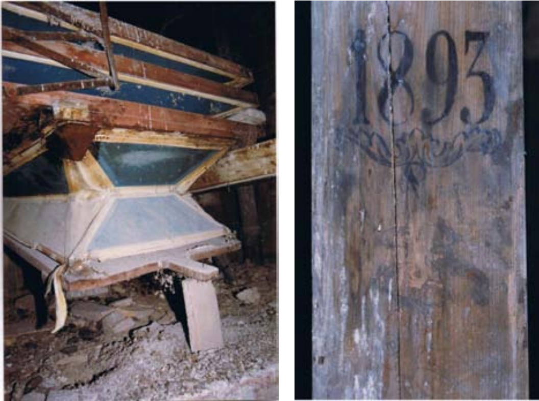
Figs.74 i 75. Esquerra: Una de les dues bombes de la manxa construïda per Joan Florenzano (avui dia desapareguda). Dreta: Palanca que permetia el moviment de les dues bombes de la manxa, detall's en la data de 1893 (avui dia desapareguda).
