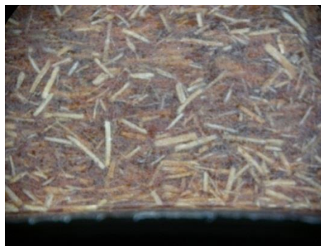
Fig. 5-9: Observación óptica de la superficie (skin) de una probeta de HDPE reforzado con un 40% de sisal.
