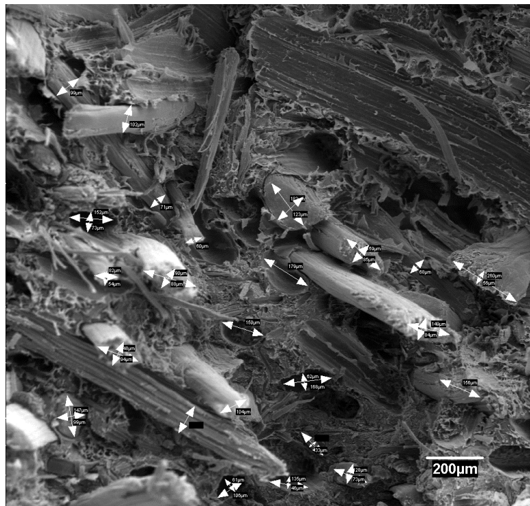
Fig. 5-24: ANÁLISIS cuantitativo de micrografías SEM de la fibra de Sisal(40%) dentro del compuesto HPDE. Sin agente de acoplamiento.
