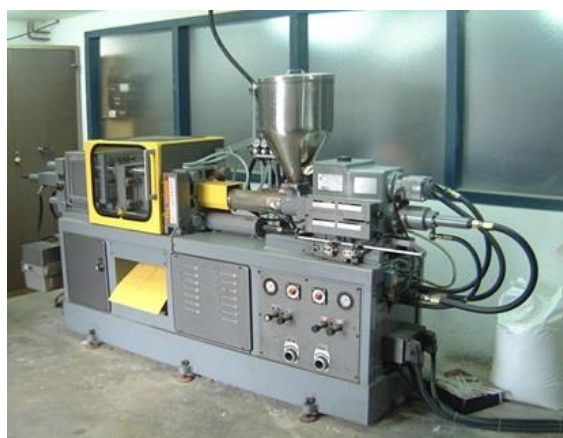
Fig. 4-12: Máquina de inyección de plástico METEOR-40.
