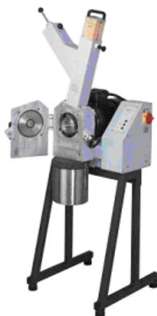
Fig. 4-10: Molino de cuchillas para granza.
