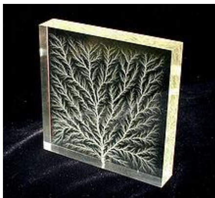
Fig. 5-52: Fractal generado con una descarga eléctrica.
