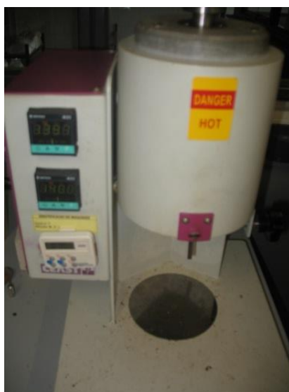
Fig. 4-11: Aparato de medición de la viscosidad MFQI.
