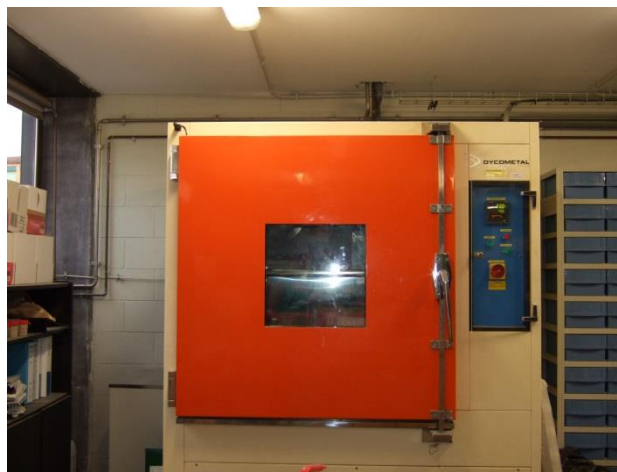
Fig. 4-14: Cámara climática DYCOMETAL.
