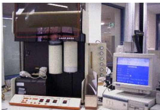
Fig. 4-28: ASAP 2000 - Aparato para determinación de superficie de BET.
