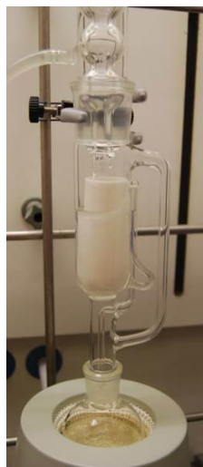
Fig. 4-17: Soxhlet utilizado para extracción de fibras del compuesto.
