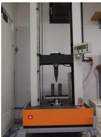
Fig. 4-15: Máquina universal para ensayos mecánicos Instron 1122.
