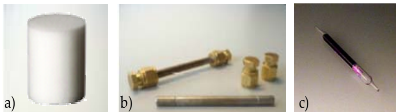
Figura 10. a) Escuma de poliuretà (PUFs), b) Tubs de Tenax per a posterior desorció tèrmica c) Tubs amb carbó per a posterior desorció líquida.
