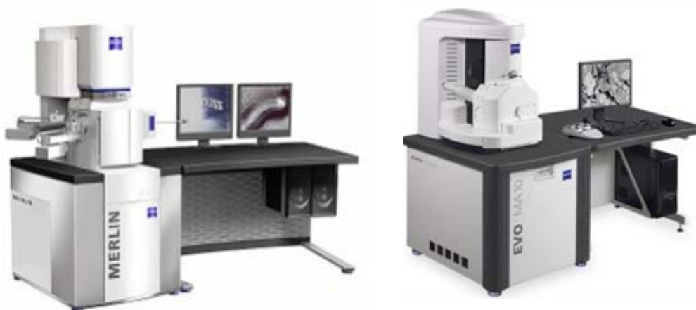
Figura 3.14. Equipos de microscopía electrónica de barrido, utilizados para la caracterización de las membranas estudiadas.
