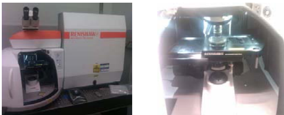
Figura 3.21. A la izquierda Microscopio Raman (Renishaw InVia RE04) y a la derecha lentes del microscopio, zona de ubicación de la muestra y zona del láser.
