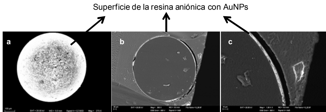
Figura 4.48. Imágenes SEM de las resina aniónica modificada con AuNPs, que muestra la imagen de la a) esfera completa y b) el corte transversal de la resina. A la derecha, c) se muestra una ampliación del corte transversal.
