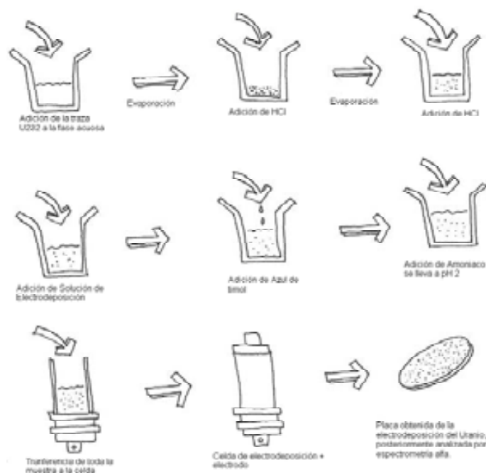
Figura 3.6. Esquema del proceso de preparación de muestras para la electrodeposición del uranio.
