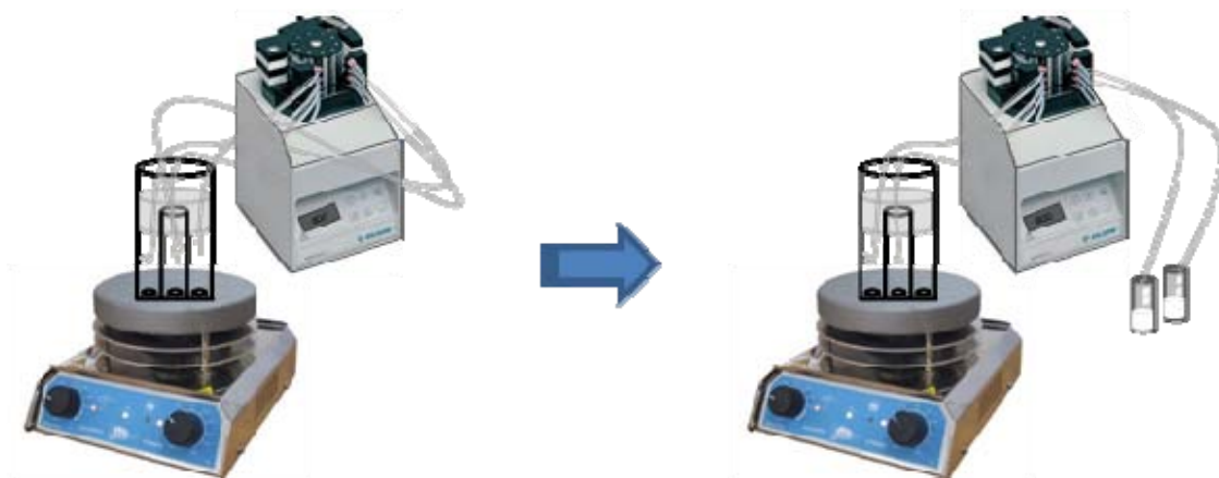
Figura 3.11. Esquema de las membranas líquidas de volumen, usando sistema de recirculación de la muestra para posteriormente tomar alícuotas no contaminadas de la fase orgánica.
