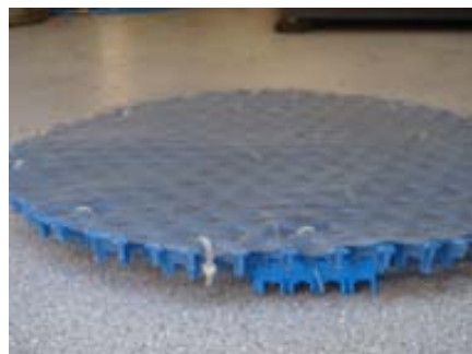
Figura 3.5 Imagen de la rejilla de los reactores planta PP1
