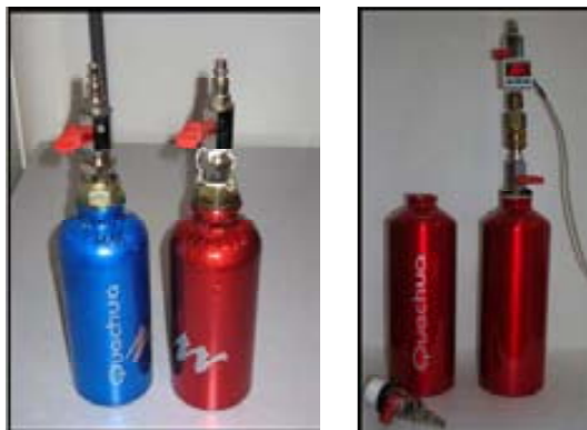
Figura 3.9 Imágenes de las botellas del ensayo anaeróbico
