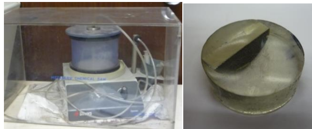
Figura III.5. Campana de vacío y probetas obtenidas tras la embutición
