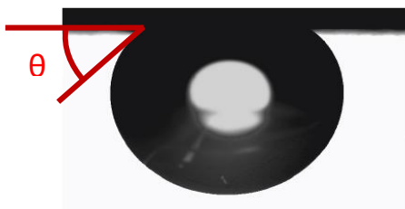
Figura III.2. Ángulo de contacto medido por "captive bubble" [1]
