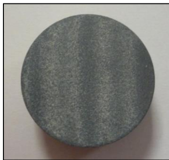
Figura VI.2. Superficie de una probeta tras la proyección (caso C, distancia 180 mm).
