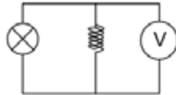
Figura 100. Un voltatge sempre s'ha de connectar en paral·lel als elements del circuit entre els que vol mesurar una DDP.
