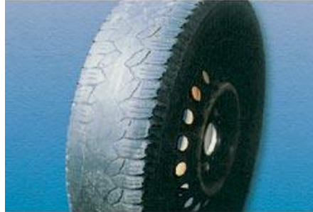
Figura 79. Exemple del desgast dels pneumàtics d'una roda produït pel fregament entre la roda i el terra.
