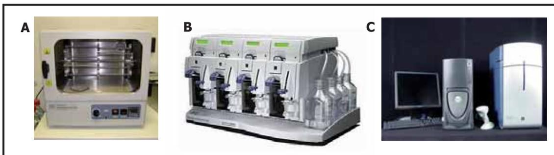
Figura 19. Equipos de la Plataforma Affymetrix para microarrays. A) horno de hibridación, B) estación de fluidos 450 y C) escáner Affymetrix 3000. Imágenes adaptadas de Affymetrix (<http://www.affymetrix.com>).
