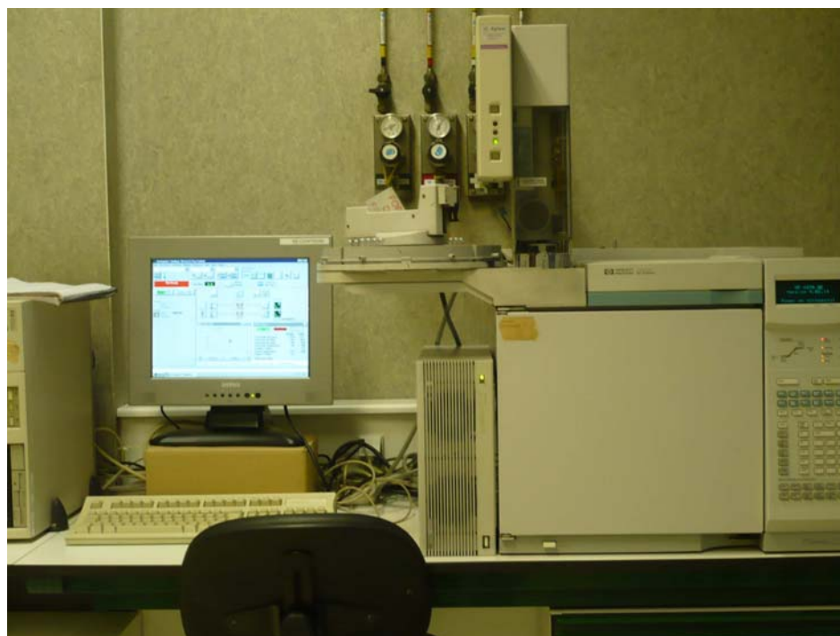
Figura 5.1: Equipo utilizado para la determinación de la riqueza en cocaína de los decomisos.
