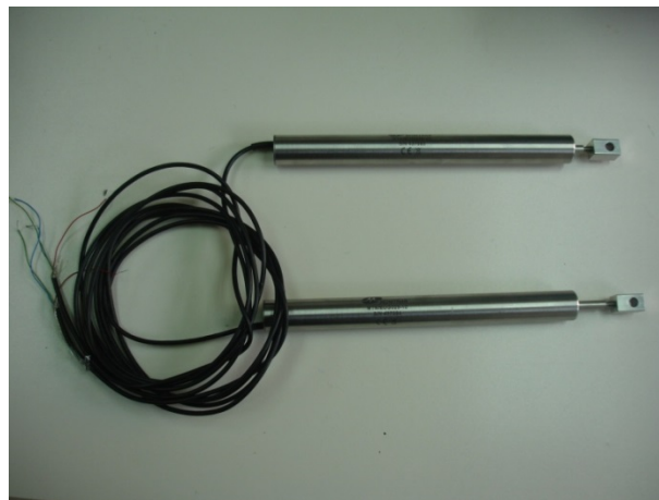
Figura 74.-Captadores de desplazamiento
