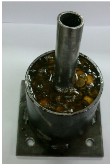
Fig. 60.- Resina con carga metálica antes del fraguado
