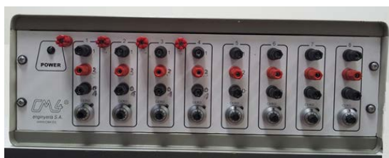
Figura 78.- Vista de los 8 canales del multiplexor
