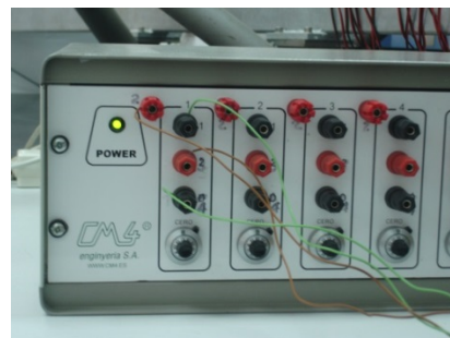
Figura 71.- Las dos galgas longitudinales del captador de fuerza se conectan en el canal 1 del multiplexor, en \frac{1}{2} puente en ramas opuestas
