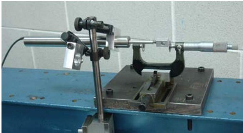
Figura 76.-Fijación de un captador de desplazamiento para su calibración
