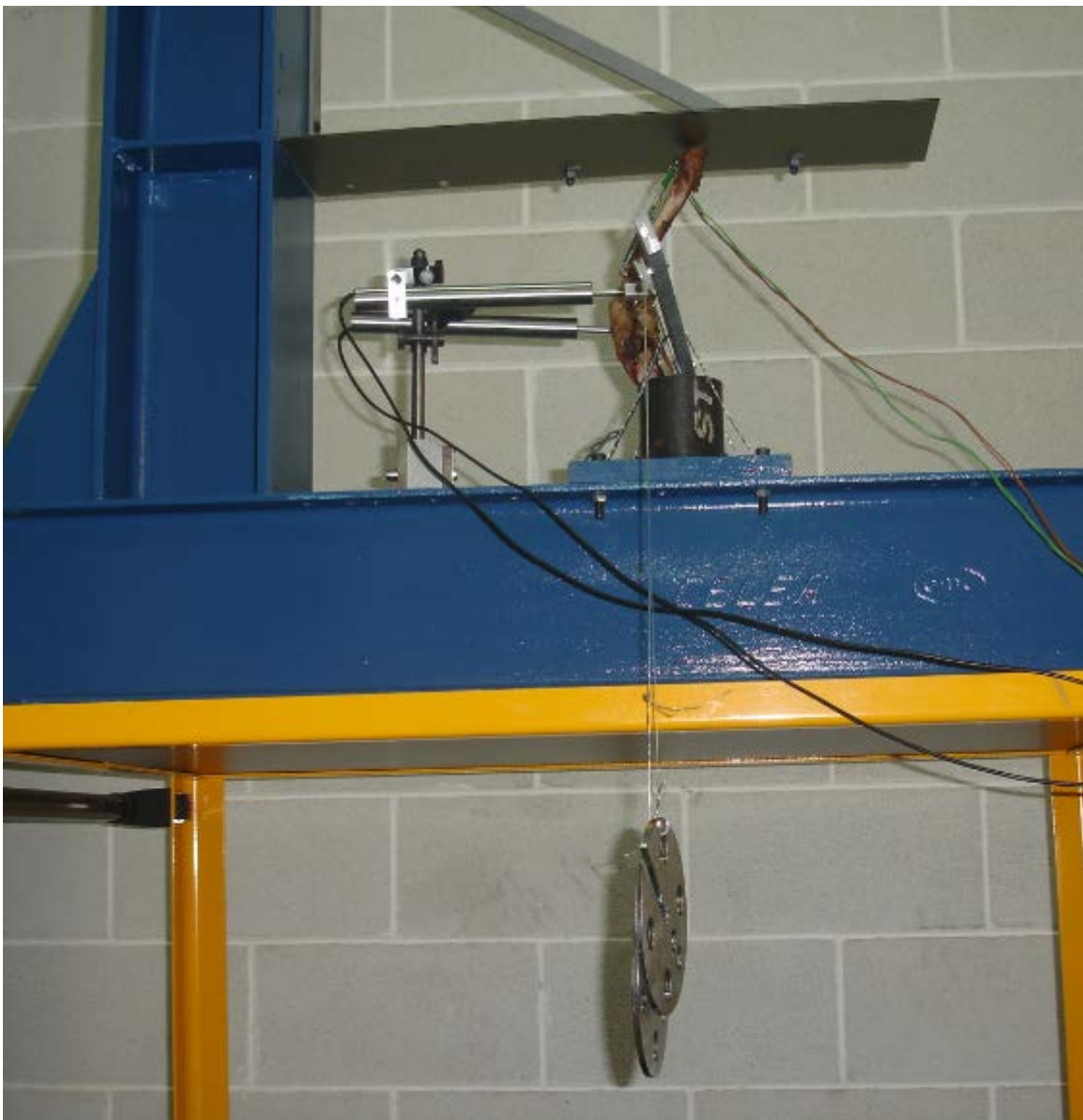
Figura 85.- Sistema de tensión que simula tendón de Aquiles
