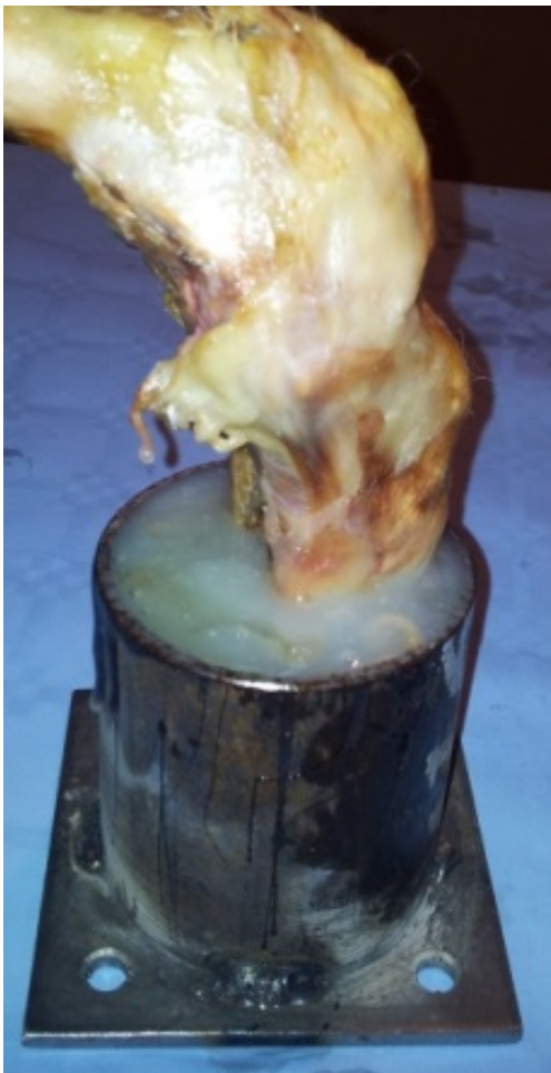
Fig. 57.- Especimen incluido en composite de fijación
