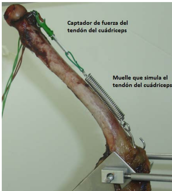
Figura 86.- Muelle que simula el tendón del cuádriceps y captador de fuerza
